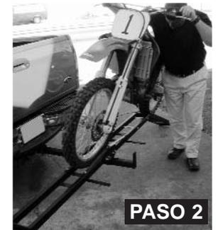
Con los pies bien colocados sobre el suelo y la motocicleta en posición neutro, súbala lentamente por la rampa de carga hasta colocarla en el portamotocicleta. Si es necesario, pida ayuda a otra persona.
