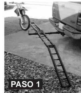
La rampa de carga se puede usar por ambos lados del portamotocicleta. Verifique que el reborde de la rampa quede bien enganchado en la base de la rampa.
