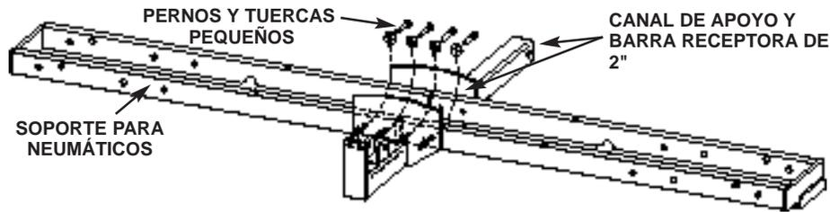
**PASO 2.** Fije los 2 soportes del puente, como se ilustra, y los 2 soportes de la rampa, con 4 pernos, arandelas y tuercas medianos. **Nota:** Al instalar los soportes de la rampa, verifique que la superficie lisa quede orientada hacia arriba y que sobresalgan 3 pulgadas hacia fuera, para que éstos soporten la rampa durante el transporte.
