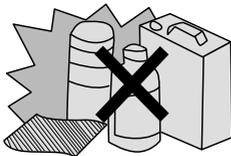
4. Nunca moje el interior del equipo de aire acondicionado con agua. Los componentes eléctricos se encuentran en la parte interior del equipo.
