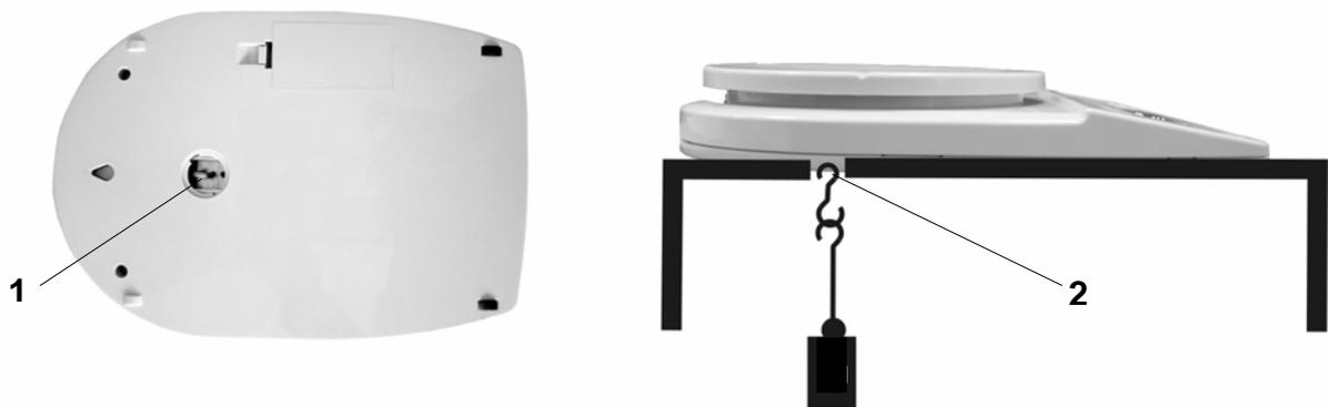
Fig. 1: Ajuste de la balanza para pesaje inferior.
