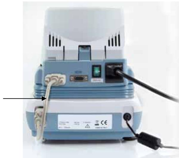
Conectar el aparato únicamente a un enchufe con toma a tierra (PE) instalado correctamente. La protección puede fallar si se usa un alargador desprovisto de cable protector. En el caso de alimentación mediante un enchufe sin toma a tierra, una protección equivalente ha de ser instalada por un especialista, conforme a los reglamentos de instalaciones eléctricas.
