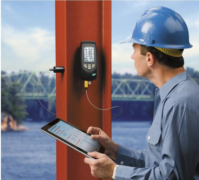
**PosiTector Dew Point Meter (DPM) con Kit de Temperatura de Superficie**
