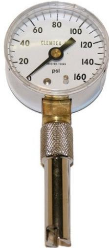
**Medidor de Apertura de Boquilla**
