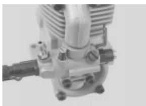
El tornillo de tope del ralentí, ajusta el cierre del barril del acelerador.
