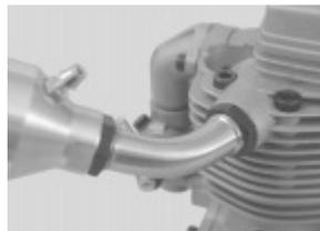
La rosca del silenciador y la del codo de escape, que luego se enrosca en el lado de la cabeza del cilindro. Ambos conjuntos se mantienen en su lugar con dos tuercas.
