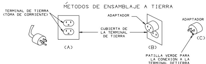
**PELIGRO.** Antes de utilizar el adaptador como se muestra asegúrese de que el tornillo central de la toma de corriente esté conectado a tierra. La patilla verde del adaptador debe estar conectada a tierra. Si es necesario cambie el tornillo de la tapa de la toma de corriente por uno más largo para asegurar que la patilla haga una buena conexión a tierra.
