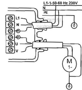
Diagrama de conexionado para bombas monofásicas de 230V hasta 1,1 kW
