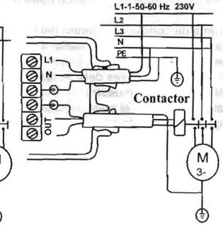
Diagrama de conexionado para bombas trifásicas de 380V. A través de control remoto
