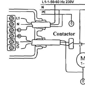
Diagrama de conexionado para bombas monofásicas de 230V hasta 1,1 kW. A través de control remoto
