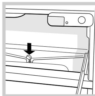
actividad para descongelar el frigorífico. La única intervención que se debe realizar periódicamente consiste en limpiar el orificio de descarga para que el agua pueda fluir libremente.
