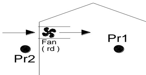
Mediante la salida de Alarma será posible realizar cualquier acción como por ejemplo interrumpir la salida de regulación "rd" se la temperatura externa es demasiado fría o habilitar la regulación diferencial solo entre la banda de temperatura establecida o también combinar diferentes acciones.
