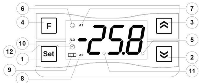
**1 – Tecla SET:** Pulsando y soltando rápidamente se accede al cambio de Set Point diferencial. Pulsando durante 5 segundos se accede a la modalidad de programación de parámetros. En la modalidad de programación se utiliza para acceder a editar los parámetros y para confirmar el valor.
