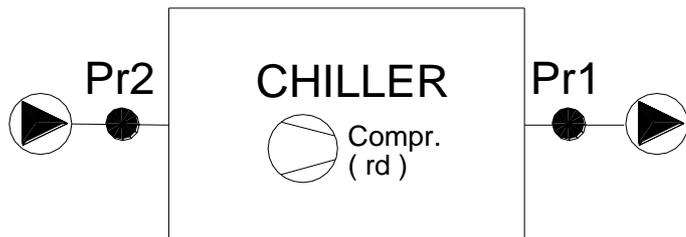
Si la temperatura del agua en la salida (Pr1) es igual o mayor a la entrada (Pr2), tiene una diferencia de temperatura (Pr1-Pr2) mayor del valor [SPd+r.dd] el regulador debe activar la salida "rd" que, activa un sistema frigorífico, enfriará el agua a la salida del chiller. Durante el funcionamiento del sistema frigorífico la temperatura medida de la sonda Pr1 tenderá por tanto a disminuir.
