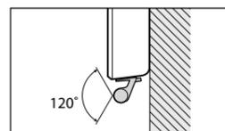
Ajustez l'angle de l'émetteur de synchronisation 3D en fonction de l'installation.
