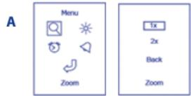
Durch Drücken der Tasten neben der Multifunktionstaste (9) verstellt man den Cursor auf das Symbol der Einstellung Funktion Zoom, (A). Wenn der Cursor auf dem gewünschten Symbol steht, zum Bestätigen die in der Mitte befindliche Multifunktionstaste (9) drücken. So gelangt man zum Nebenmenü der Einstellung Funktion Zoom (B).
