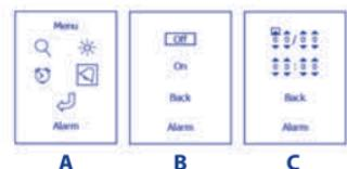
Pressionando os botões laterais do botão multifunções (9), desloque o cursor sobre o ícone de definição e activação de despertar/lembrete 'alarm', (A).
