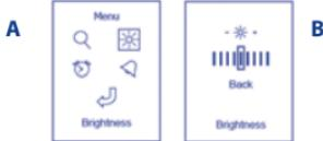
Pressionando os botões laterais do botão multifunções (9), desloque o cursor sobre o ícone de regulação da intensidade da retro-iluminação do mostrador LCD, 'Brightness', (A).
