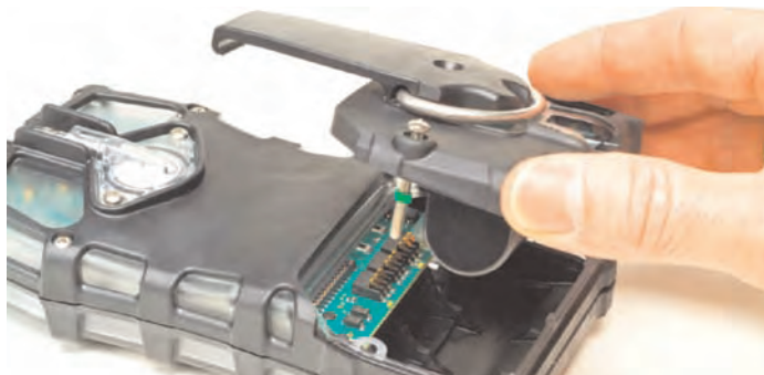
Figura 4-1. Cambio de la batería
