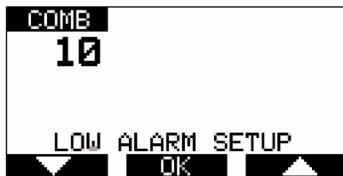
Figure 3-6. Réglage des alarmes de capteur
