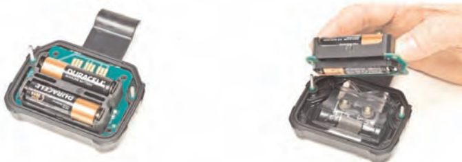
Figura 4-2. Cambio de la batería
