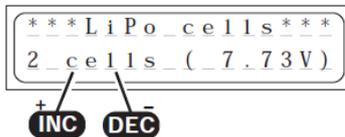
**¡Atención! Es imprescindible colocar correctamente el número de elementos, ya que si no la batería puede explotar o incendiarse**
