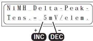
La tensión del corte automático (en mV por elemento) puede ajustarse para los acumuladores de NiMH.
