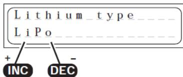
Este es el programa de ajuste más importante para los acumuladores de litio. El tipo de acumulador se determinará en esta selección. Esto ha de ser cuidadosamente ajustado y verificado, ya que el cargador mueve todos los otros parámetros de carga en función de estos ajustes. El ajuste de los tipos de acumuladores (LiPo, LiIo o LiFe) influye en la tensión de corte. Si un acumulador de Litio solamente recarga 2/3 de su capacidad es que se ha seleccionado mal el tipo de acumulador.
