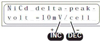
El corte de carga automático (Detección de la plena carga del acumulador) funciona según el procedimiento Delta-Peak probado millones de veces (denominado también Delta-U o Delta-V). Estos
