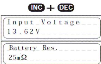
Podemos acceder a la lectura de la tensión de entrada y la resistencia actual de la batería (solamente en el modo manual de NiCd y NiMH) en cualquier momento pulsando **simultáneamente** las teclas INC y DEC. Según si pulsamos las teclas INC o DEC podemos cambiar entre la visualización de la resistencia interna, las tensiones separadas de los elementos o la tensión de entrada.
