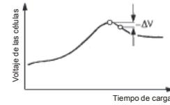
procedimientos valoran la tensión máxima de la curva de carga, la cual calcula exactamente el punto de carga máximo.
