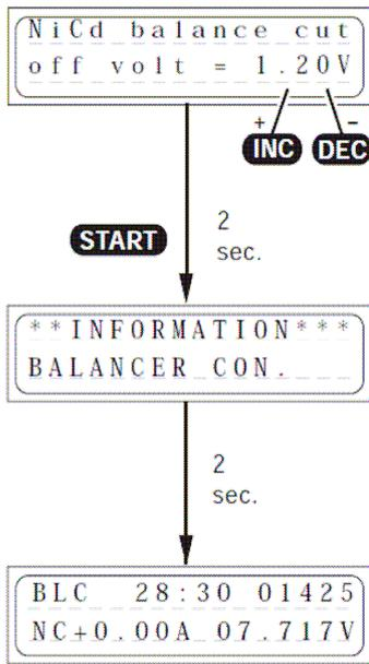
Este programa sirve para equilibrar la tensión de los diferentes elementos de los packs de acumuladores de 2-6 elementos. Ajustar la tensión del fin del balanceo 1.20 ... 1.30 V con las teclas INC o DEC.
