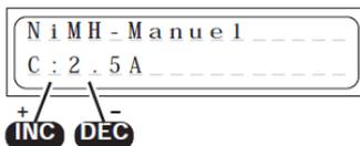
Con este programa el acumulador se cargará con la corriente de carga ajustada. La corriente de carga máxima puede ajustarse de 0,1 A a 5 A con las teclas INC/DEC, sin limitación, antes de la conexión del acumulador.
