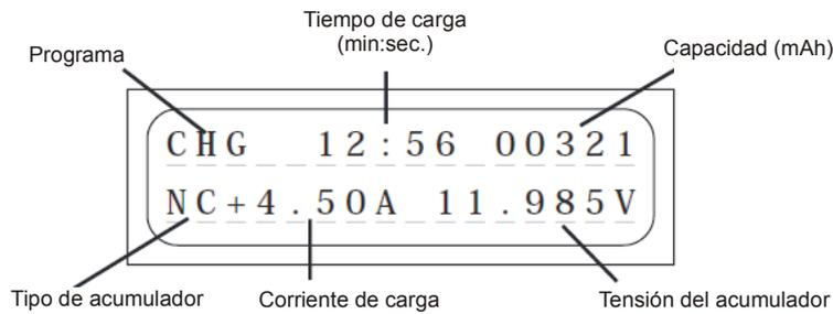
Durante los procesos de carga / descarga, los datos importantes serán claramente visibles en la pantalla de cristal líquido de dos líneas hasta la desconexión del acumulador. Al empezar la carga de un nuevo acumulador, los valores mostrados anteriormente ya no serán más visibles.
