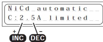
En este programa el cargador detecta el tipo de acumulador NiCd conectado y adapta la corriente de carga en consecuencia, de manera que no se puede producir una sobrecarga de los packs.
