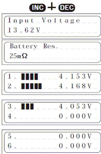
Podemos acceder a la lectura de la tensión de entrada y la resistencia actual de la batería (solamente en el modo manual de NiCd y NiMH) en cualquier momento pulsando **simultáneamente** las teclas INC y DEC. Según si pulsamos las teclas INC o DEC podemos cambiar entre la visualización de la resistencia interna, las tensiones separadas de los elementos o la tensión de entrada.
