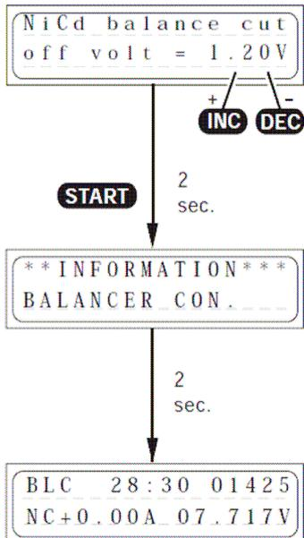
Este programa sirve para equilibrar la tensión de los diferentes elementos de los packs de acumuladores de 2-6 elementos. Ajustar la tensión del fin del balanceo 1.20 ... 1.30 V con las teclas INC o DEC.
