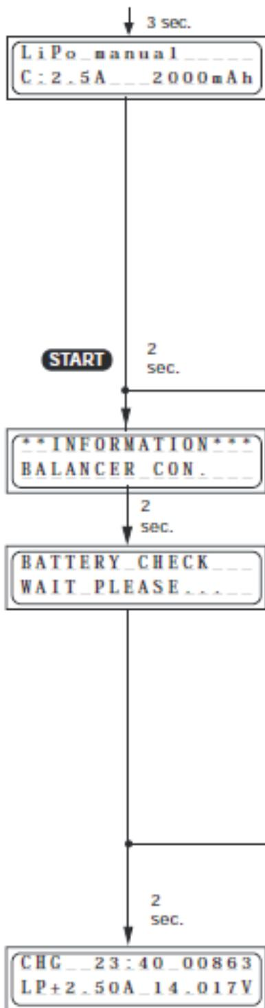
Para la carga, descarga y el reciclado, seleccionar el programa a utilizar como se describe a continuación y colocar los valores que necesitamos. Si lo hay colocar el conector del balanceador en la entrada de balanceo.
