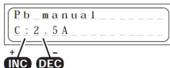
Con este programa, la corriente de carga máxima admisible para la batería que se tiene que cargar se ajustará con las teclas INC/DEC, antes de su conexión al cargador.
