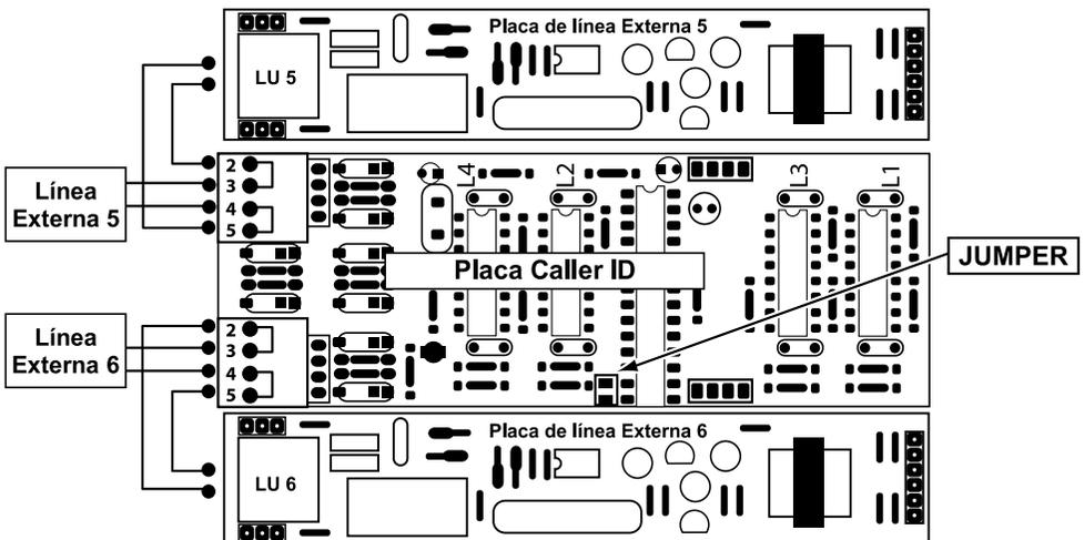
placa Caller ID en la primer placa base, y para las líneas 3 y 4 se deben conectar en paralelo la entrada de cada línea con la entrada de cada Caller ID, de igual forma como se muestra en el gráfico para las líneas de expansión 5 y 6.
