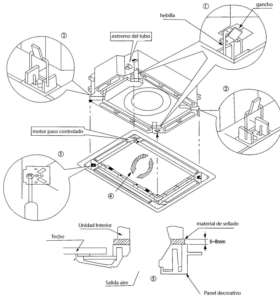
Después de apretar los tornillos, reajuste la altura de la unidad para verificar que no existe separación entre el techo y el panel decorativo.
