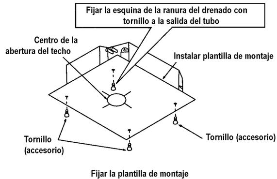
1. Para comenzar a instalar la unidad interior, sujete la placa de montaje con las varillas roscadas; asegúrese de utilizar roldanas y tuercas en los dos extremos de la placa respectivamente. Fije la placa de montaje firmemente. Utilice la plaquita auxiliar para evitar que las roldanas se resbalen.
