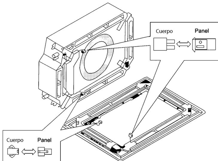
**Nota: Las dos terminales conectadas con el panel deben estar colocadas dentro de la caja eléctrica y cubiertas por la tapa de la caja eléctrica.**
