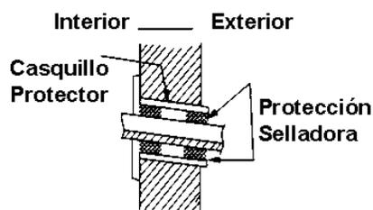
**Si no se utilizara un casquillo protector, entonces será necesario perforar un orificio recto en la pared. Si este orificio no resulta recto y uniforme, podría provocar fugas de agua por la condensación provocando daños en la propiedad.**
