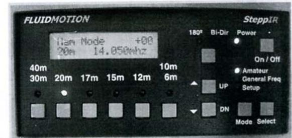
**Controlador 80m-6m** - Este es el controlador que se usa con la antena vertical BigIR con la bobina para 80m instalada.
