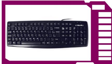
**Teclado.** Es el principal dispositivo de entrada de información de un equipo de cómputo y se conecta en la parte trasera de la misma. Existen dos conectores del mismo tipo, pero normalmente se indica cuál de ellos pertenece al teclado porque se distinguen con dos colores. Insértalo correctamente.
