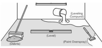
Para nivelar la superficie donde se va a hacer la instalación es necesario tener presentes los siguientes materiales: Nivelador, compuesto de nivelación, escoba para remover escombros y pala para esparcir el compuesto.
