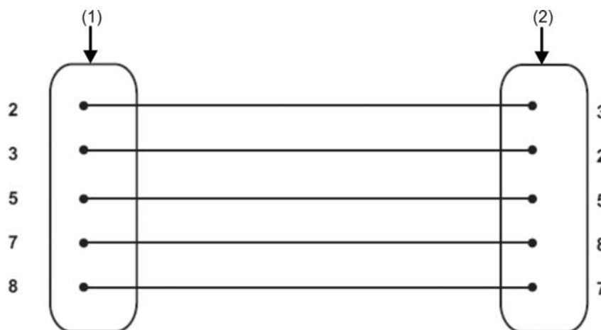
Figura 15: Conexiones del cable RS-232
