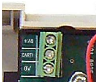
Figura 10: Terminales de la fuente de alimentación
