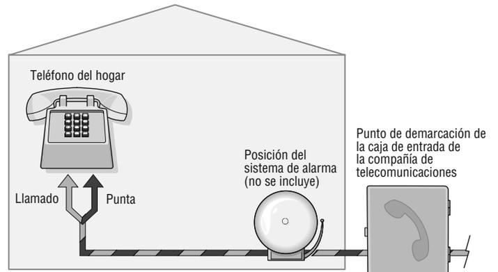
**NOTA:** Si la unidad se conectará con un sistema de alarma, primero debe conectar la línea telefónica al sistema de alarma en la serie desde la caja de la compañía de telecomunicaciones. Si las unidades no están conectadas en este orden, no funcionarán correctamente.
