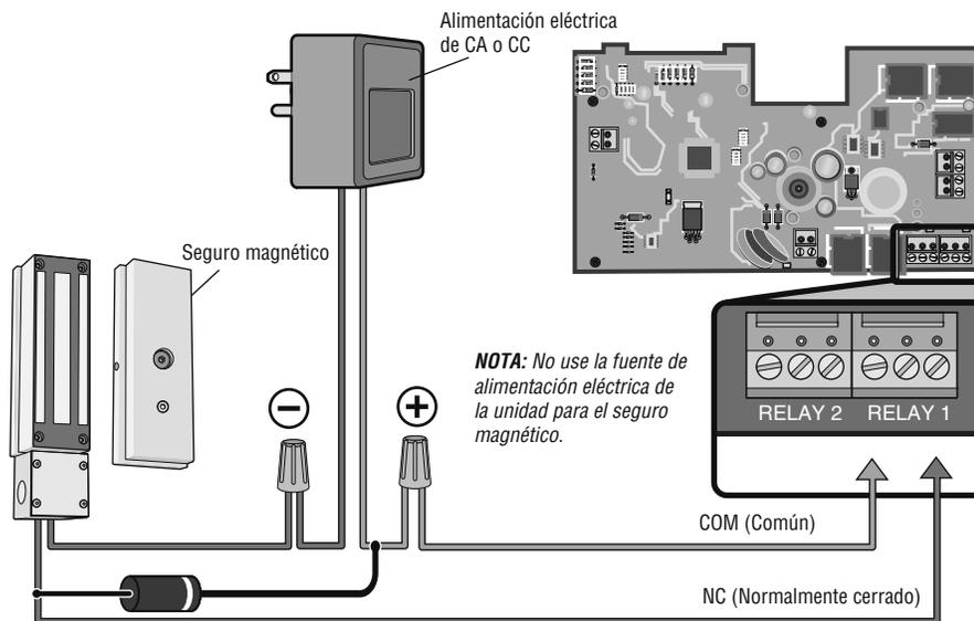
**NOTA:** Para alimentación eléctrica de CC, instale un diodo 1N4001 o uno equivalente.
