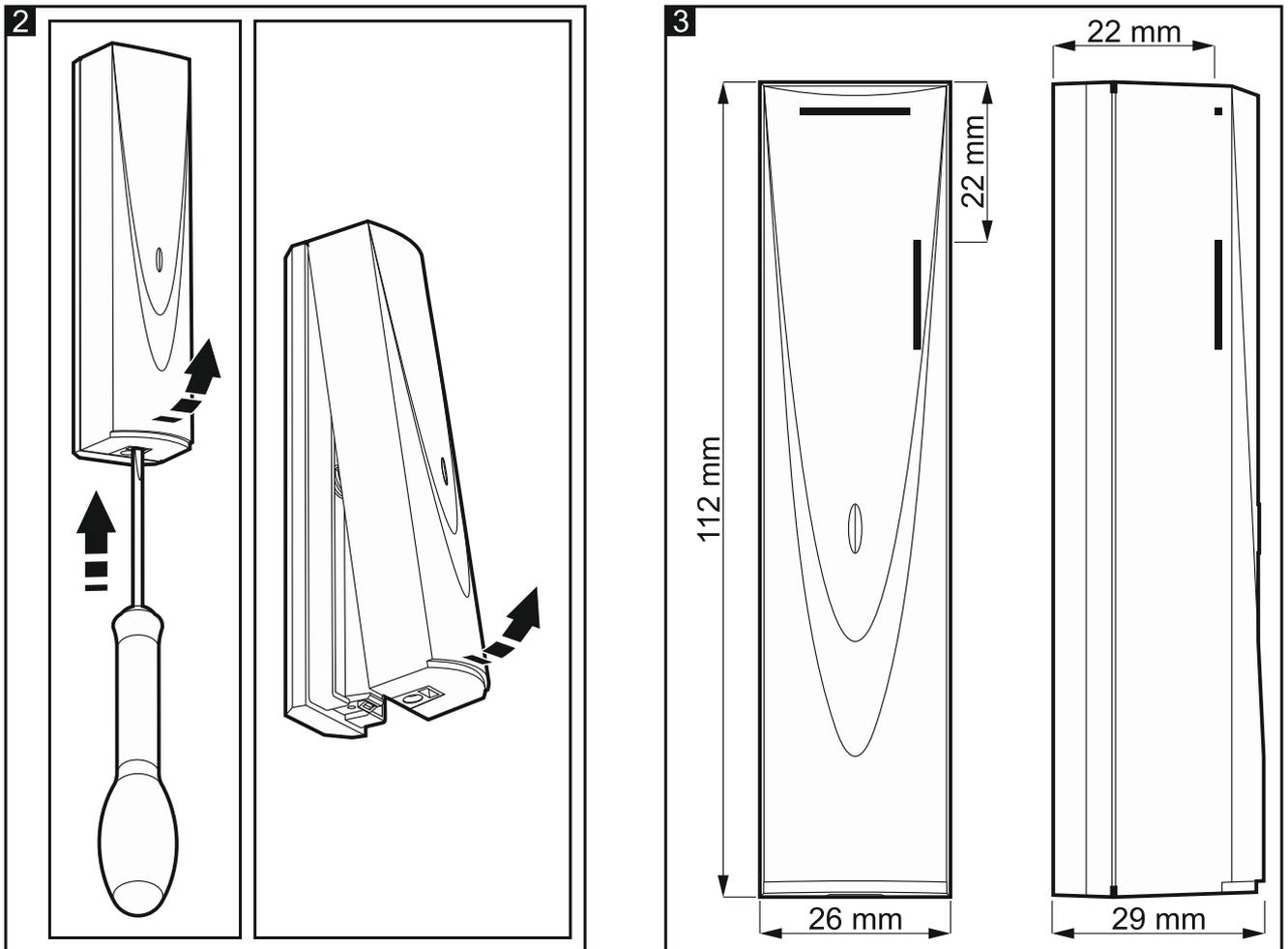
2. Instalar la pila y añadir el detector al sistema inalámbrico (ver: manual del controlador ACU-100 / ACU-250 / ACU-120 / ACU-270 o manual para el instalador de la central de alarma INTEGRA 128-WRL / VERSA). La etiqueta con el número de serie de 7 dígitos que introducimos al registrar el detector en el sistema, se encuentra en la placa electrónica.
