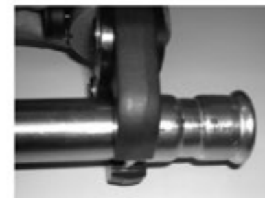
Abra la mordaza, aplíquela en ángulo recto y efectúe el prensado. Open the jaw, place at a right angle and carry out the pressfitting.
