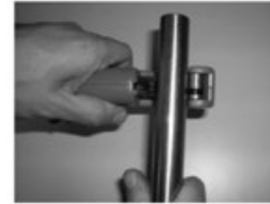
Corte el tubo en ángulo recto. Cut tube at right angle.
