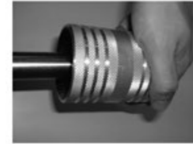
Desbarbe el tubo por dentro y por fuera para no dañar la junta. Debur the tube internally and externally so as not to damage the seal.
