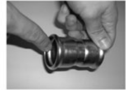
Examine si la junta está colocada apropiadamente. No emplee aceite ni grasa. Check the seal is properly placed. Do not use oil or grease.
