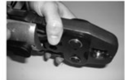
Coloque la mordaza de prensar en la máquina e inserte el perno de sujeción hasta que encaje. Place the pressfitting jaw in the machine and insert the fastening bolt until it fits.
