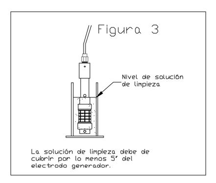
**IMPORTANTE:** NUNCA MEZCLE LA SOLUCIÓN DE VINAGRE O ÁCIDO CON HIPOCLORITO DE SODIO. NUNCA USE ÁCIDO PURO PARA LIMPIAR EL ELECTRODO. NUNCA ACTIVE EL CONVERTIDOR DC-A-DC MIENTRAS EL ELECTRODO ESTÁ EN LA SOLUCIÓN DE ÁCIDO.
