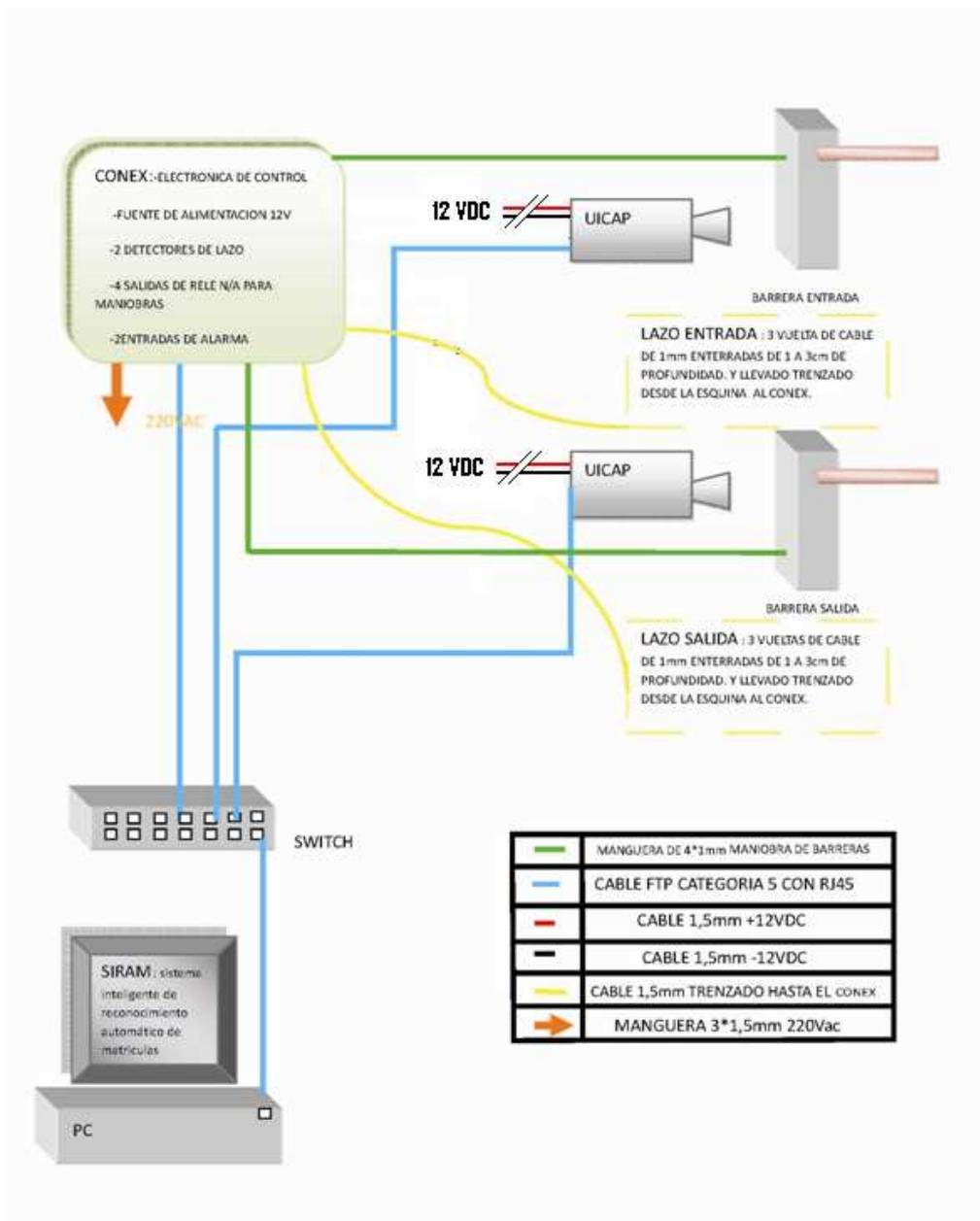
En distancias superiores a 100 metros el cable FTP o UTP se deberá cambiar por uno de fibra para evitar que se pierda la señal. Para distancias superiores a 50 metros se debe colocar una fuente de alimentación lo más cerca posible a la UICAP.
