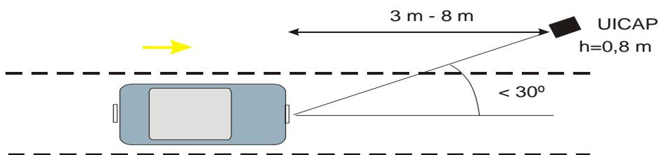
Figura 3. Plantilla Ubicación Física Elementos Siram
