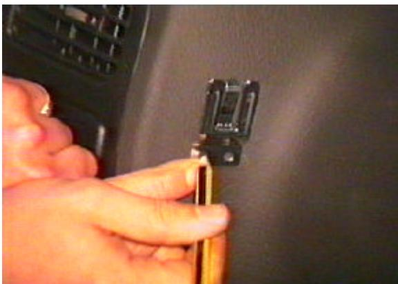
FIG3: Señalización de los taladros que sujetan la pinza fijación micrófono.
