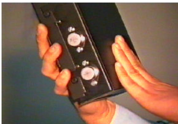
FIG 5: Extracción de la caja amplificadora de su base (Presionando y desplazándola frontalmente).
