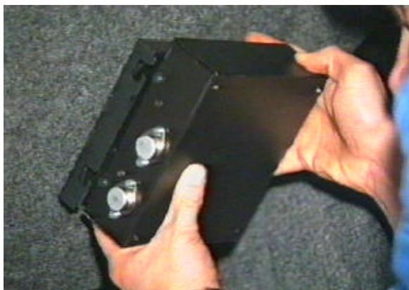
FIG 7: Colocación del amplificador sirena, sobre su base soporte.
