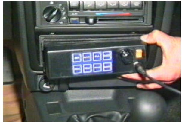
FIG. 2: Colocación del modulo de control sobre su base fijación, presionando fuertemente sobre el mismo.
