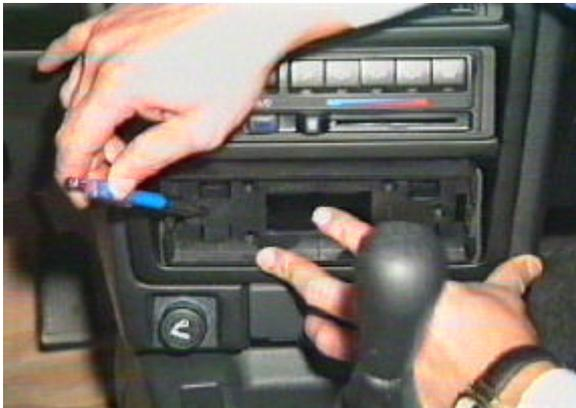
FIG. 1: Utilización de la base soporte modulo de control como plantilla para marcar los taladros de fijación.
