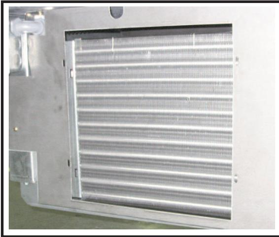
El bloqueo del flujo de aire aumenta el consumo de energía y reduce la capacidad del exhibidor de mantener la temperatura de operación.
