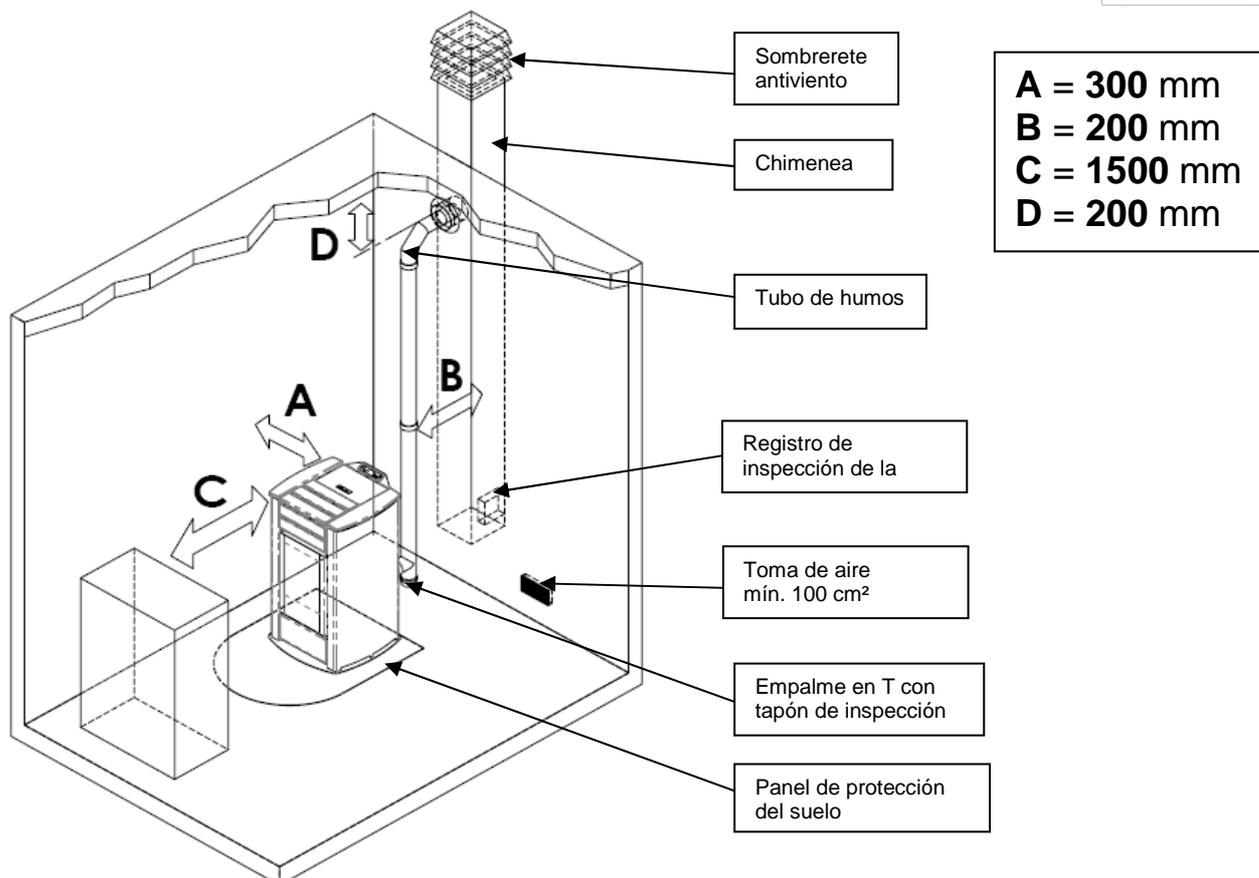
Alrededor de la estufa debe quedar espacio suficiente y de fácil acceso para hacer el mantenimiento periódico. La estufa tiene cuatro pies regulables para compensar los posibles desniveles del suelo. Para nivelarla, inclínala ligeramente y gire el pie que necesite regulación.
