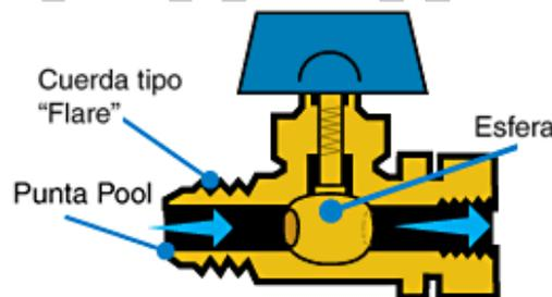
Se recomienda la instalación adicional de una válvula de esfera para gas en un lugar accesible para poder cerrar el suministro de gas en caso de emergencia o cuando el equipo o vaya a usarse por periodos prolongados de tiempo.
