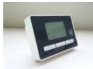
El módulo de mando a distancia comunica permanentemente con la central IDEO. El modulo está equipado con dos pilas tipo AA – 1,5 V – LR6. Su vida, con una utilización normal (consulta por el usuario 5 veces al día, de promedio) se estima para una duración de unos 3 años. El nivel de carga de las pilas se visualiza directamente en la pantalla (Referencia 10)..
