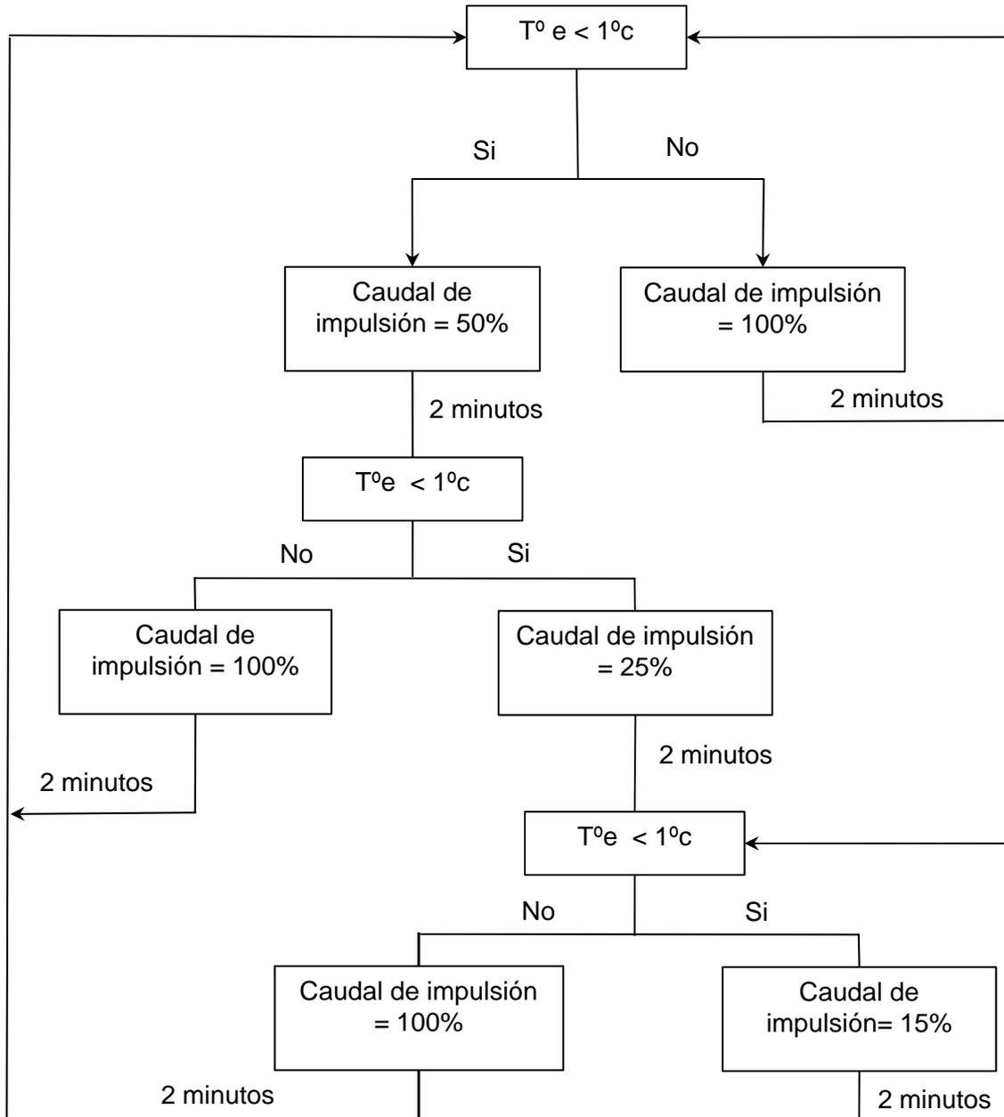
T°e = Temperatura sobre la extracción de la casa después del intercambiador
