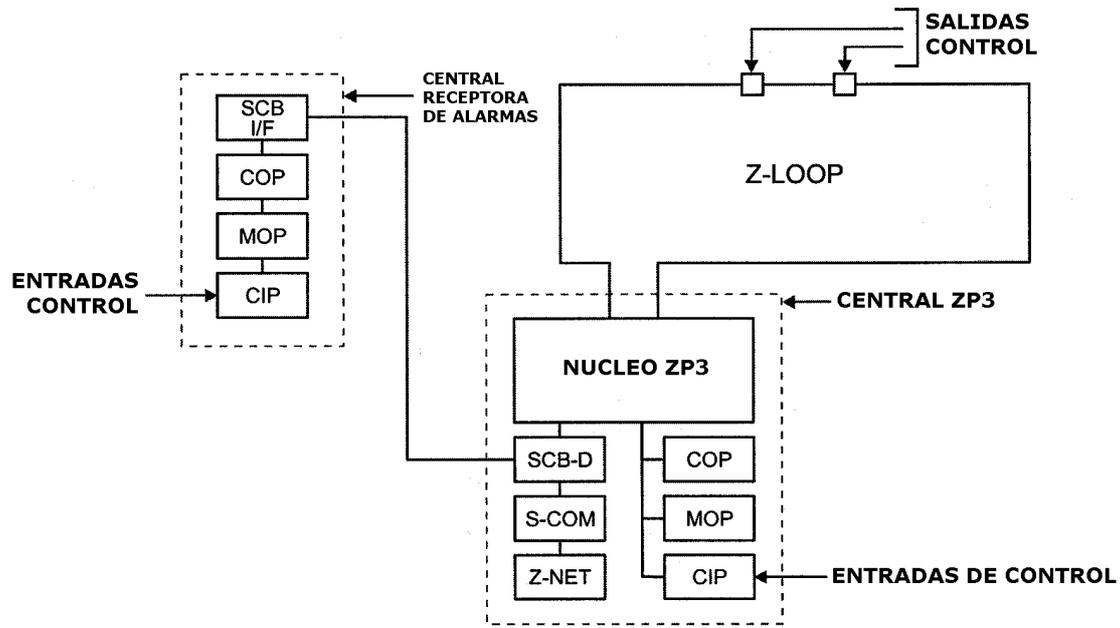
La central ZP3 soporta la conexión de entradas de control para la supervisión de elementos externos. Estos elementos deberán de disponer de un contacto libre de tensión el cual realizará el cambio de estado de la entrada al conmutar de una posición a otra.
