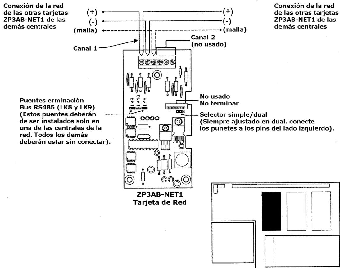
La longitud máxima del cable apantallado del RS485 podrá ser de hasta 2000 metros. El cableado podrá ser punto a punto o bien en estrella. El total del cable de red no podrá exceder de 2000 metros. Si las distancias de la red son superiores a 2000 metros, entonces se deberán de utilizar amplificadores RS485, o bien un enlace de fibra óptica. Vea las instrucciones del bus SCB para mas detalles.
