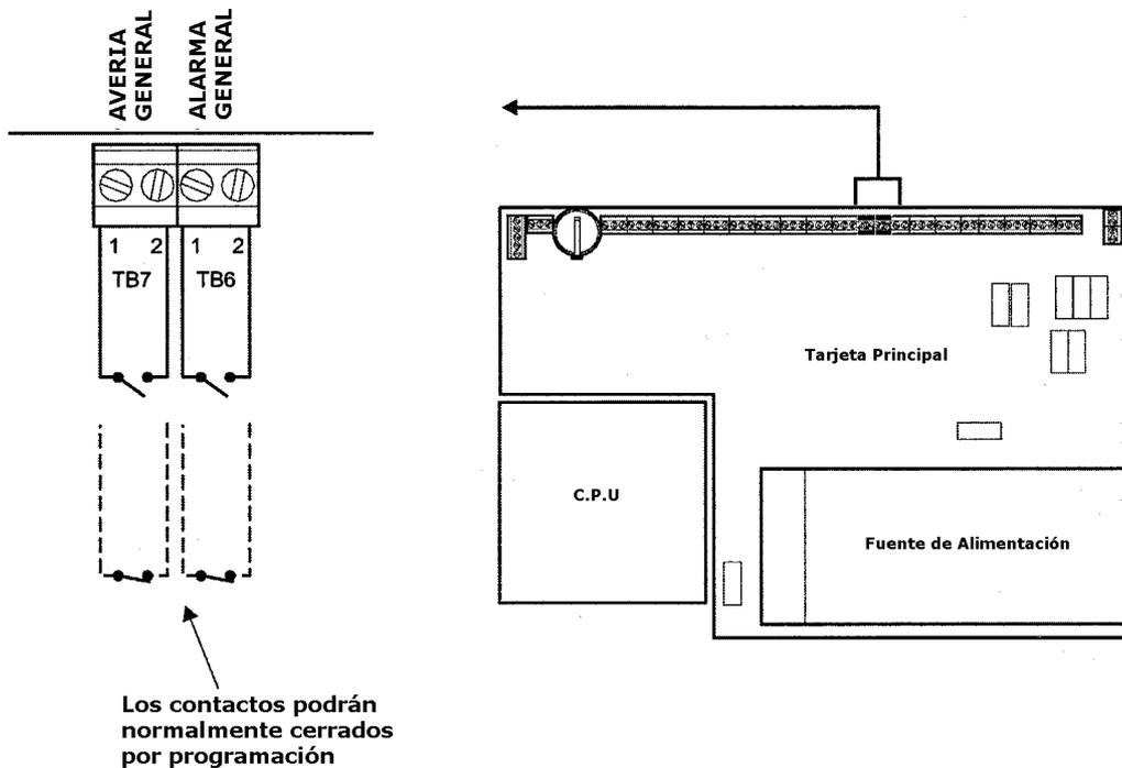
Los contactos permiten conmutar una corriente de hasta 1 amperio, y con una tensión máxima de 24 Vdc o 100 Vac.
