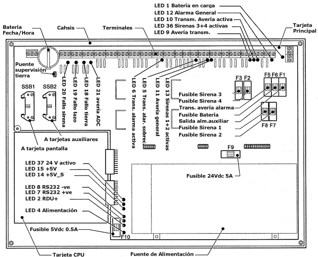
El chasis podrá ser extraído de la central quitando 4 tornillos. Una vez extraído, no puede ser desensamblado, ya que bajo el circuito puede haber presencia de alta tensión incluso sin la alimentación principal conectada.
