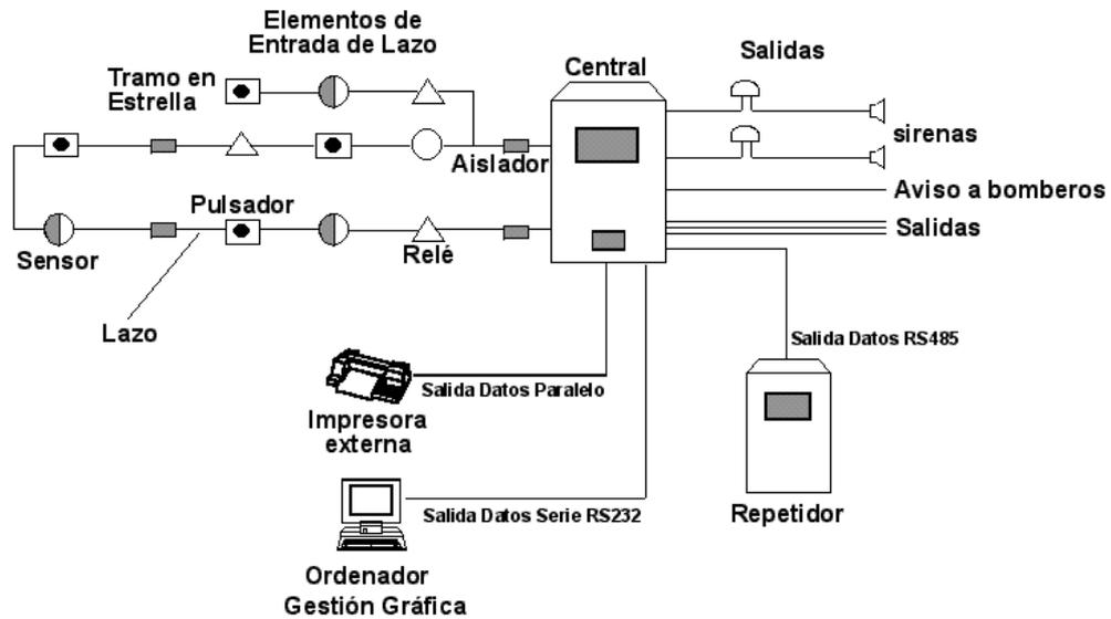
Esquema 2.3.1 Sistema autónomo
