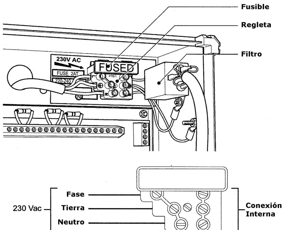
Asegúrese que el cable de la alimentación principal se encuentre debidamente conectado. El cable de esta conexión deberá de ser lo mas corto posible y deberá de estar separado de los cables de los lazos de la central y de los cables de datos.
