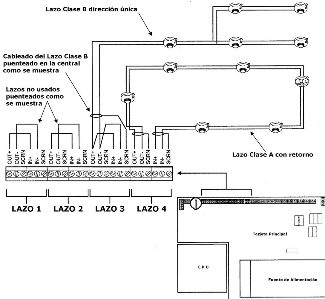
Cuando se use el formato de cableado de Clase B de dirección única, entonces los terminales de entrada del lazo deberán de estar puenteados localmente en la central, uniendo positivo de salida con positivo de entrada y negativo de salida con negativo de entrada.
