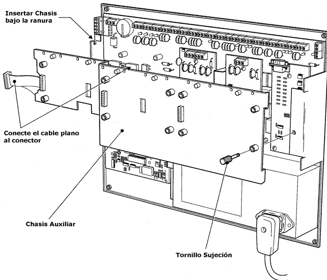
El chasis dispone de un cable plano. A este cable se conectarán hasta 3 tarjetas auxiliares. El chasis auxiliar está diseñado para simplificar la instalación de estas tarjetas, y para permitir de forma sencilla el acceso a la tarjeta principal tras la instalación del mismo.
