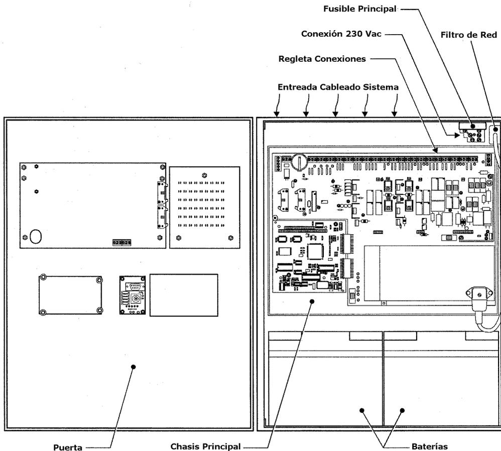
La central esta diseñada para separar las partes de chasis principal, puerta y armario de forma sencilla. El propósito de esto será permitir realizar la instalación eléctrica básica de armario, el cual dispone de las entradas para tubos o cables necesarios en su parte superior y posterior. Se dispone de hardware adicional para diferentes instalaciones.
