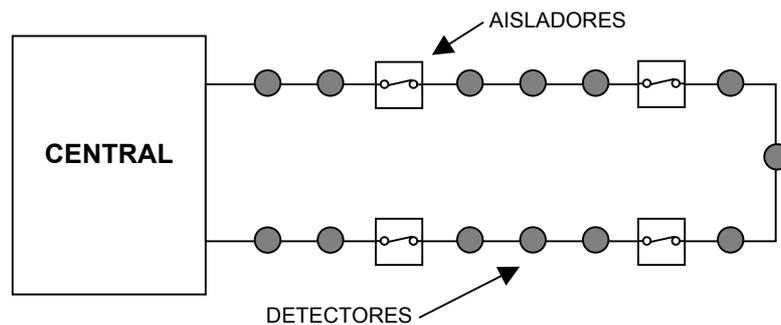
Esquema 3.4.2 Esquema del uso del aislador de línea
