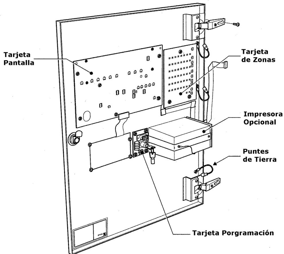
La puerta podrá ser extraída de la central quitando 2 tornillos. Deberá también desconectar los 4 cables que conectan a tierra la puerta de la central, así como los cables que se encuentran conectados en la tarjeta principal. No desensamble las tarjetas de la puerta.
