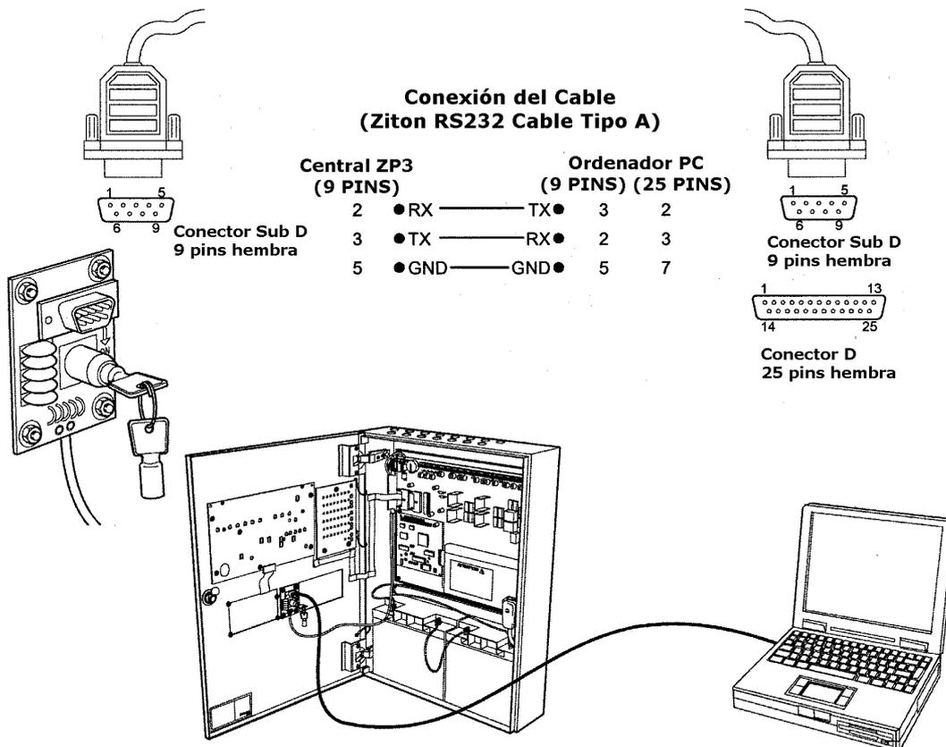
RS232 es oficialmente especificado con una longitud de cable máxima de 10 metros, el cual es más que suficiente para el propósito de las funciones de programación de la central ZP3/PC. Las conexiones o cables deberán de disponer de malla, y deberán de realizarse como se muestra en la figura anterior. Alternativamente, podrá utilizarse un cable estándar del tipo "Null Módem".
