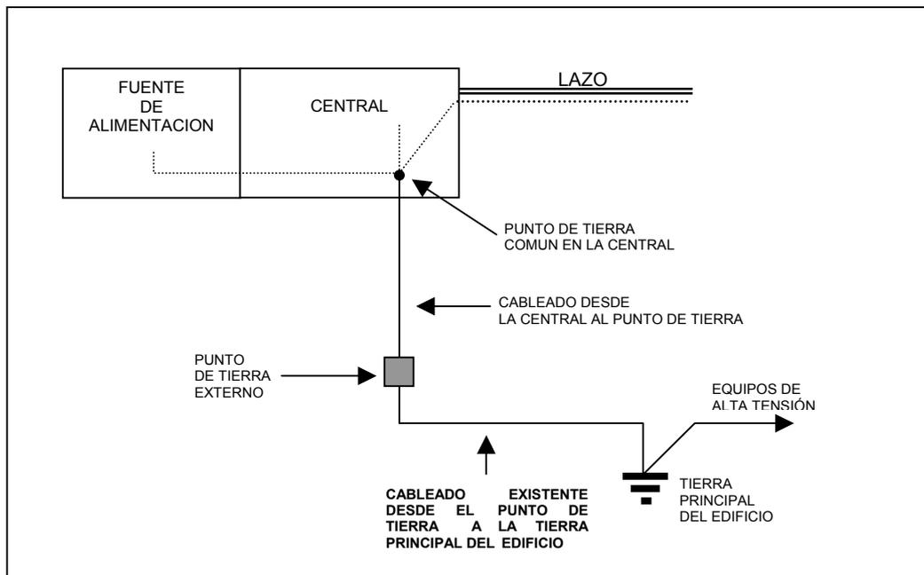
**Esquema 2.1 Conexión a tierra de la central**
