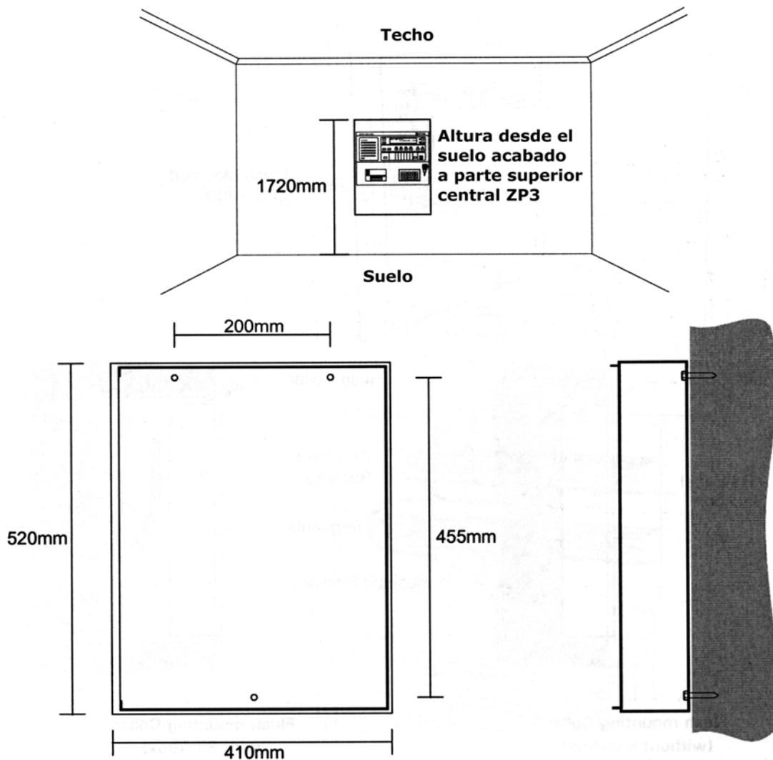
Dependiendo del tipo de pared, utilice los tornillos y tacos adecuados para su fijación. Siendo la medida mínima recomendada de M4 y con longitud de 20 mm. Escoja el sistema de montaje que soporte un mínimo de 20 Kg de peso, siendo este el peso total aproximado de la central con baterías en su interior.
