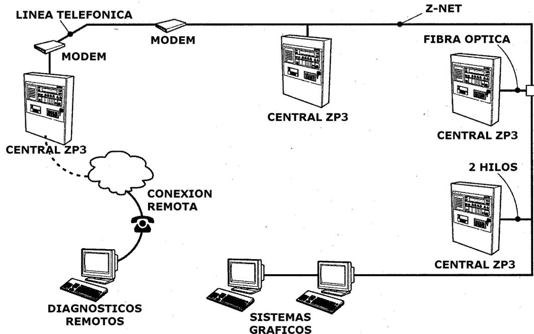
Si se utiliza el sistema Ziton "ZP-NET", se podrán interconectar hasta 32 sistemas ZP3 en una red punto a punto, creando un sistema integrado multi-central con informes globales de todo el sistema, evacuación coordinada, funciones de control causa-efecto globales, y control integrado de todo el sistema.
