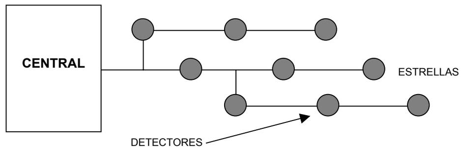
Esquema 3.3.3 Clase de cableado C
