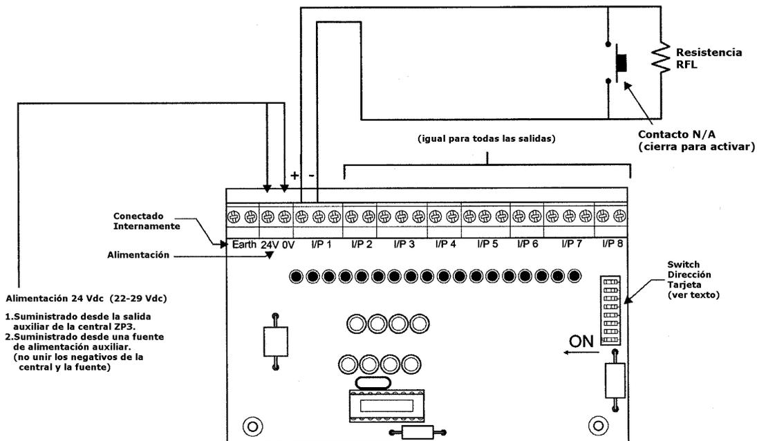
Cada tarjeta dispone de un Dip-Switch de 8 segmentos. Este dip-switch podrá establecer una dirección entre 0 y 255. Esta dirección determinará la dirección de cada uno de los relés, estando especificadas en la tabla de direcciones de la sección de programación de este mismo manual.
