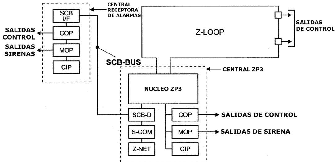
La central ZP3 soporta la conexión de salidas de control programables para varias funciones. Estando disponibles salidas por tensión o contactos libres de tensión.
