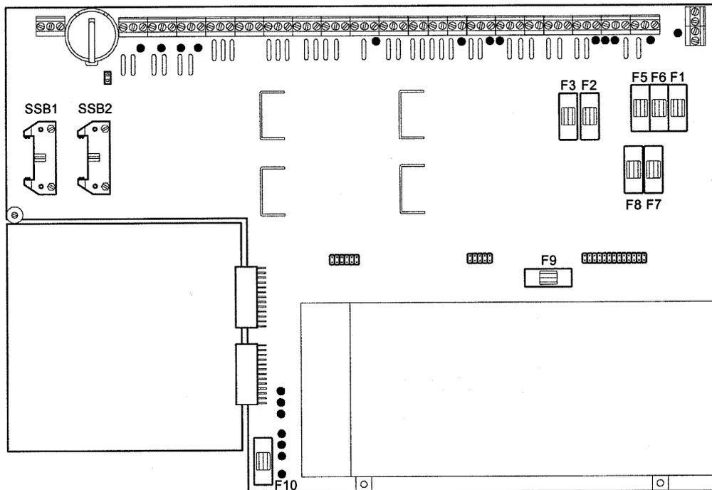
Todos los terminales aceptan cables de 0,5 mm<sup>2</sup> a 2,5 mm<sup>2</sup> de sección
