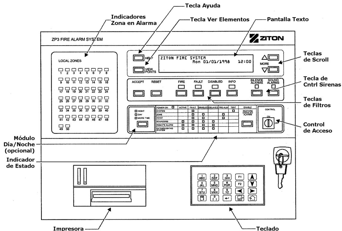
La pantalla de información esta diseñada para cumplir con los requerimientos de las normas EN54-2. Adicionalmente a las alarmas y eventos mostrados en la pantalla, también existen indicadores tipo LED para indicación de las zonas. El funcionamiento de los controles esta estructurado por niveles de acceso, disponiendo de 4 niveles. La impresora es opcional.
