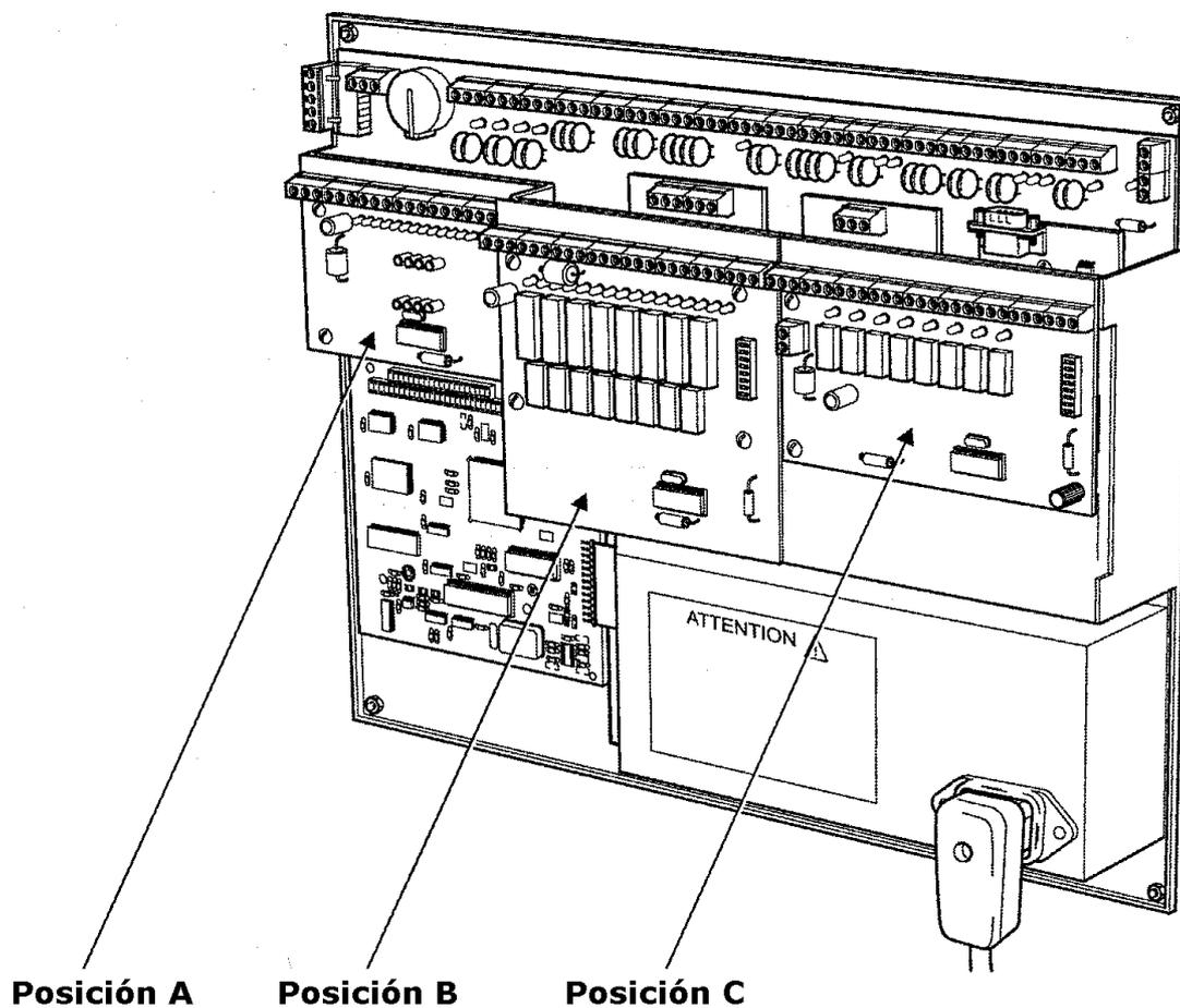
El número máximo de tarjetas auxiliares que pueden montarse en una central ZP3 es tres, las cuales pueden ser cualquiera de todos los tipos disponibles. Esto permitirá la instalación de entre 24 y 72 salidas auxiliares dentro de la central. Si se requieren tarjetas adicionales, entonces deberán de montarse en un armario separado RCU. Estando disponible varias medidas de armarios, y cada una de las centrales ZP3 podrá soportar hasta 896 salidas, de las cuales 768 serán totalmente programables.
