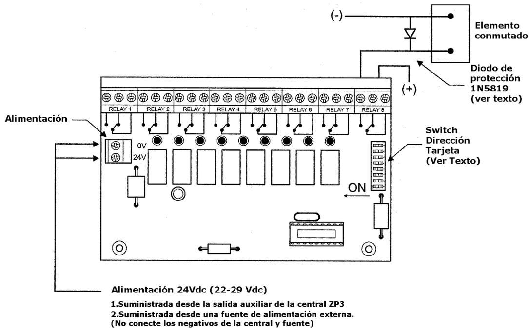
Cada tarjeta dispone de un Dip-Switch de 8 segmentos. Este dip-switch podrá establecer una dirección entre 0 y 255. Esta dirección determinará la dirección de cada uno de los relés, estando especificadas en la tabla de direcciones de la sección de programación de este mismo manual.
