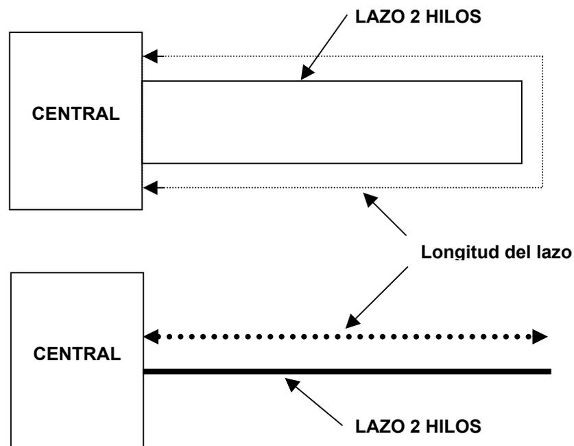
Imagen 3.7 Esquema de ilustración longitud del lazo
