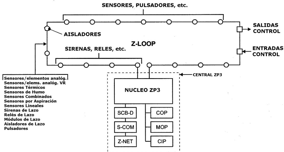
Lazo de 2 hilos el cual proporciona alimentación a los elementos conectados, así como comunicación entre los elementos y la central. Es utilizado por los elementos tales como sensores, pulsadores, módulos E/S, y sirenas de lazo. Utiliza el protocolo Ziton ZP.
