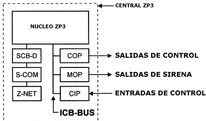
El bus interno de control (ICB) es utilizado para la conexión de las tarjetas accesorios ubicadas dentro de la central.
