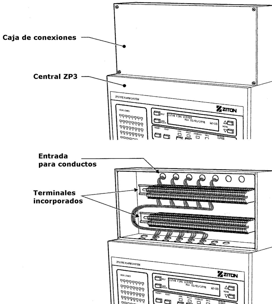
La caja de conexiones auxiliar incorpora dos carriles tipo DIN, los cuales aceptan terminales de este mismo tipo. Esto permitirá centralizar todas las conexiones en la caja de conexiones, y llevar a la central únicamente los cables necesarios.
