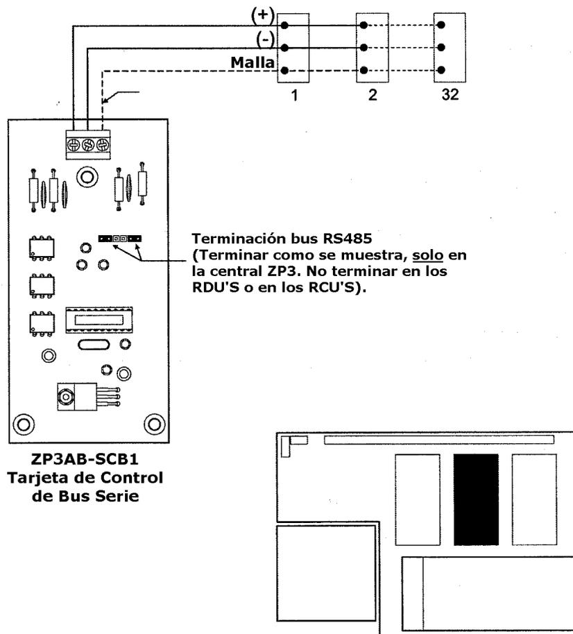
La longitud máxima del cable apantallado del RS485 podrá ser de hasta 2000 metros. El cableado podrá ser punto a punto o bien en estrella. El total del cable de red no podrá exceder de 2000 metros. Si las distancias de la red son superiores a 2000 metros, entonces se deberán de utilizar amplificadores RS485, o bien un enlace de fibra óptica. Vea las instrucciones del bus SCB para mas detalles.
