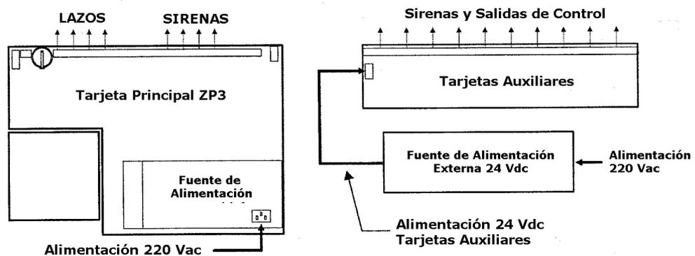
**NOTA:** NO CONECTE el 0 Voltios (negativo) de la central con las fuentes de alimentación externa.
