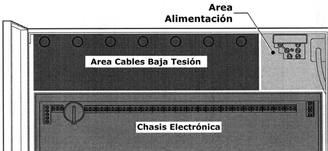
Es muy importante seguir cuidadosamente los pasos seguidamente indicados. Esto asegurará que los cables sean correctamente distribuidos a los circuitos electrónicos y tarjetas de la central, previniendo los posibles daños físicos a los componentes, y eliminando el ruido producido por la proximidad de los cables.
