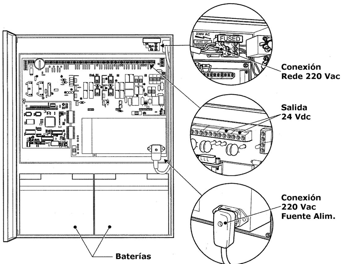
La ilustración anterior muestra la ubicación de la partes principales de la alimentación del sistema. La alimentación estándar dispone de una capacidad máxima descrita en las especificaciones, la cual no deberá de ser excedida con el sistema en carga total.
