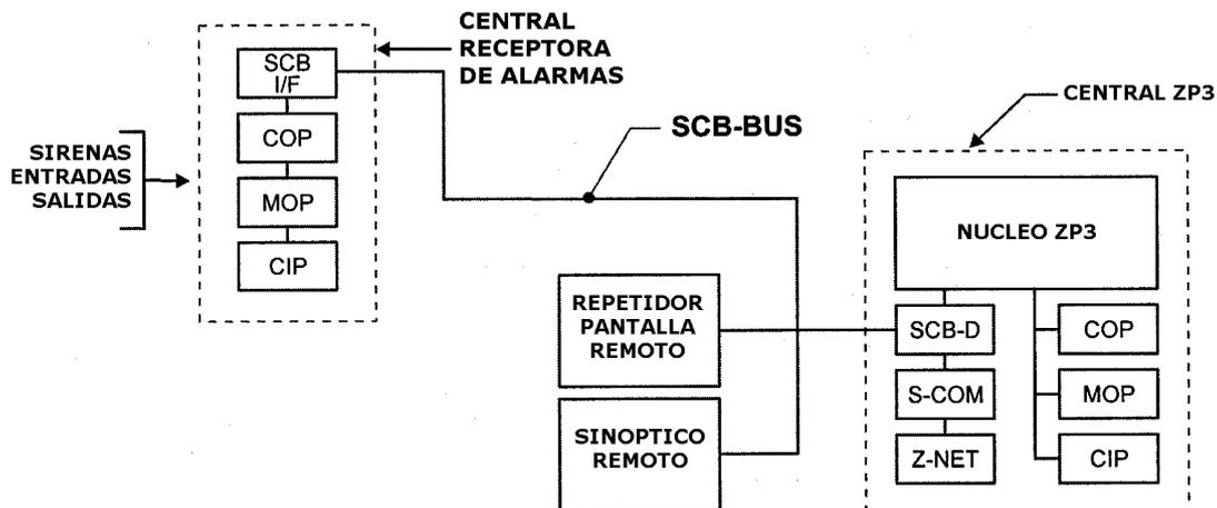
El bus de control serie (SCB) es utilizado para la conexión a la central de elementos periféricos externos tales como repetidores, unidades de control remotas, sinópticos, y elementos similares. El bus SCB es el equivalente externo del bus interno SCB descrito en la sección anterior.
