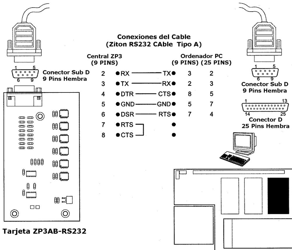
RS232 es oficialmente especificado con una longitud de cable máxima de 10 metros. aunque, si se utilizan velocidades de transmisión mas bajas, entonces será posible disponer de hasta 50 metros de longitud del cable. El cable deberá de ser apantallado, de 5 hilos, y deberá de disponer de las conexiones indicadas en el esquema anterior.
