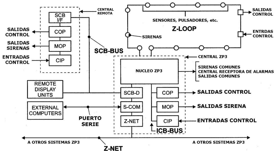
**Z-Loop** Lazo de 2 hilos el cual proporciona alimentación a los elementos conectados, así como comunicación entre los elementos y la central. Se utiliza para los elementos tales como sensores, pulsadores, módulos E/S, y sirenas de lazo.
