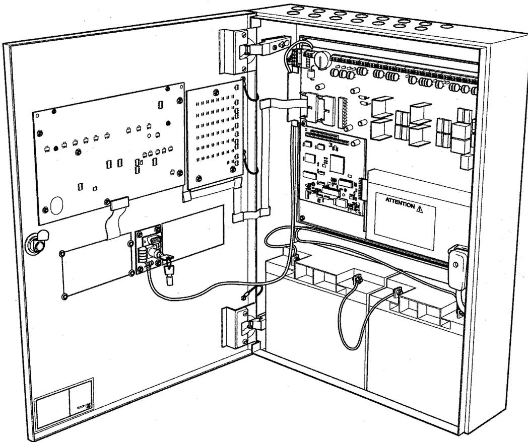
La anterior ilustración proporciona una vista de la estructura interna de la central básica. Los elementos visualizados proporcionan todas las funciones requeridas, y forma el núcleo de la central ZP3. No se visualiza ningún módulo opcional en la ilustración.
