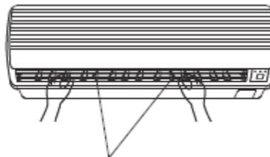
varillas de control de la rejilla de ajuste en forma horizontal
