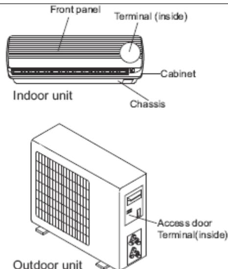
[GRÁFICO:] Panel frontal. Terminal (interior). Gabinete. Chasis. Unidad interior. Unidad Exterior: Cubierta de acceso a la Terminal (interior).
