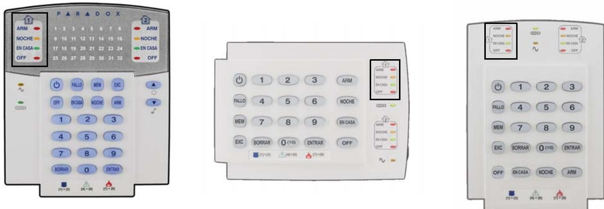
Cada vez que se pulsa la tecla **[ENTRAR]**, el teclado muestra el dígito siguiente de la sección en curso y continua a través de las siguientes secciones un dígito a la vez sin cambiar los valores programados. No está disponible para las secciones que usan el Método de Selección de Funciones Múltiples. Pulsar la tecla **[BORRAR]** en cualquier momento para salir del Modo de Pantalla de Datos.
