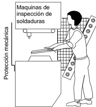
Barrera de seguridad montada en una posición oblicua evita la presencia sin detectar dentro del área peligrosa
