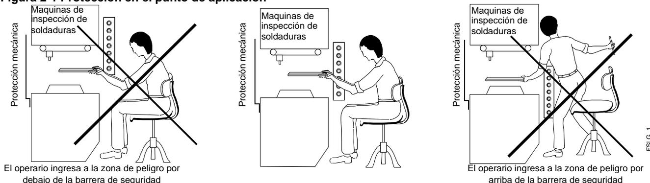
El punto de aplicación se define como aquella área donde una máquina realiza trabajo (tal como cortar, dar forma, perforar, o moldear) sobre un material.
