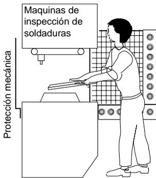
Montaje en ángulo recto de dos barreras de seguridad evita la presencia sin detectar dentro del área peligrosa
