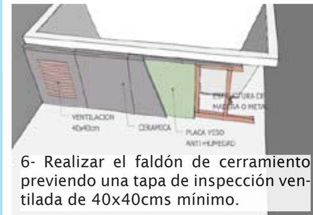
6- Realizar el faldón de cerramiento previendo una tapa de inspección ventilada de 40x40cms mínimo.
