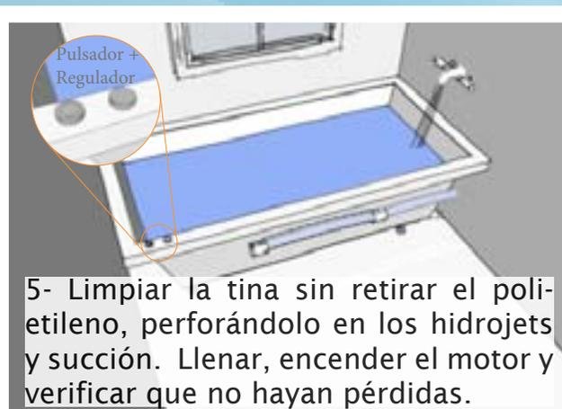
5- Limpiar la tina sin retirar el polietileno, perforándolo en los hidrojets y succión. Llenar, encender el motor y verificar que no hayan pérdidas.
