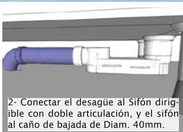
2- Conectar el desagüe al Sifón dirijible con doble articulación, y el sifón al caño de bajada de Diam. 40mm.
