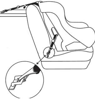
A. Asiento de seguridad instalado con LATCH, correa superior incluida
