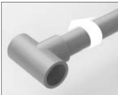
accesorio para luego instalarlo. La tubería debe entrar y llegar hasta el tope. Sujete el conjunto durante 10 a 15 segundos, para asegurar la pega inicial. **Alrededor de la junta de la tubería y del accesorio debe verse un cordón continuo de cemento. Si este cordón no es continuo alrededor del hombro del casquillo, esto puede indicar que se aplicó insuficiente cemento.** Si se aplicó cemento insuficiente, el accesorio deberá ser cortado y desechado.
