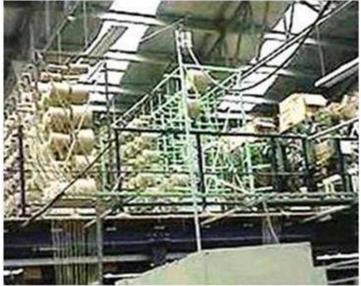
El proceso de fabricación de la tubería **PORITEX®** se efectúa en máquinas especialmente diseñadas para tal fin, las que entran su tejido en forma tubular, el que posteriormente se plancha para su óptimo manejo (flete) y queda con una apariencia de que sus extremos están pegados.
