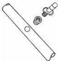
Mediante un taladro, se perfora perpendicularmente la tubería de PVC en el punto donde desea conectarse la línea de **PORITEX®**. En el orificio practicado se inserta una anilla de goma flexible (gromith), a la que después se introduce el conector (16 mm estándar del mercado) para la conexión con el tubo **PORITEX®**.
