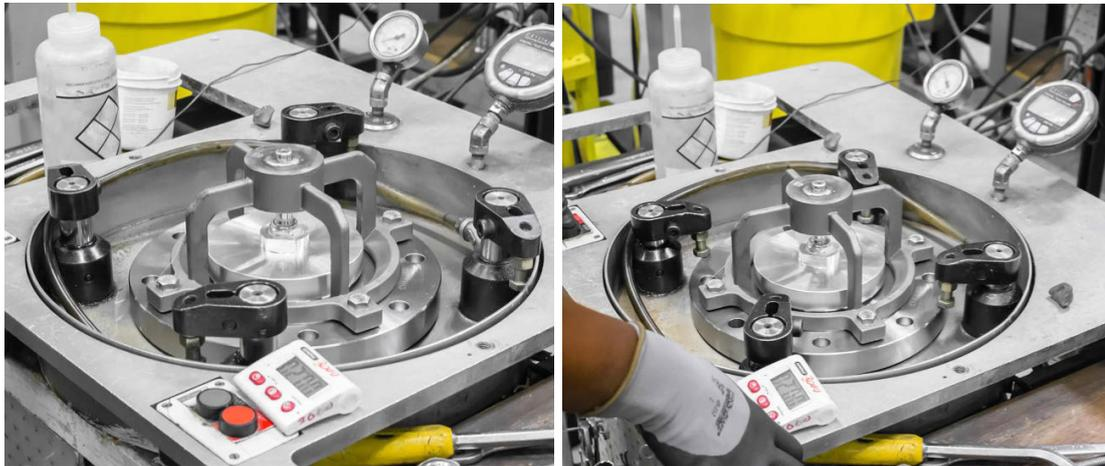
Figura 7-1 Colocación de la válvula en el accesorio para pruebas
