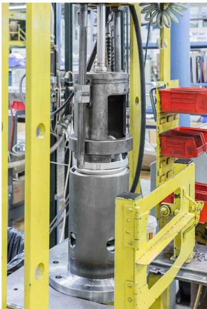
Figura 8-4 Compresión del resorte de la válvula
