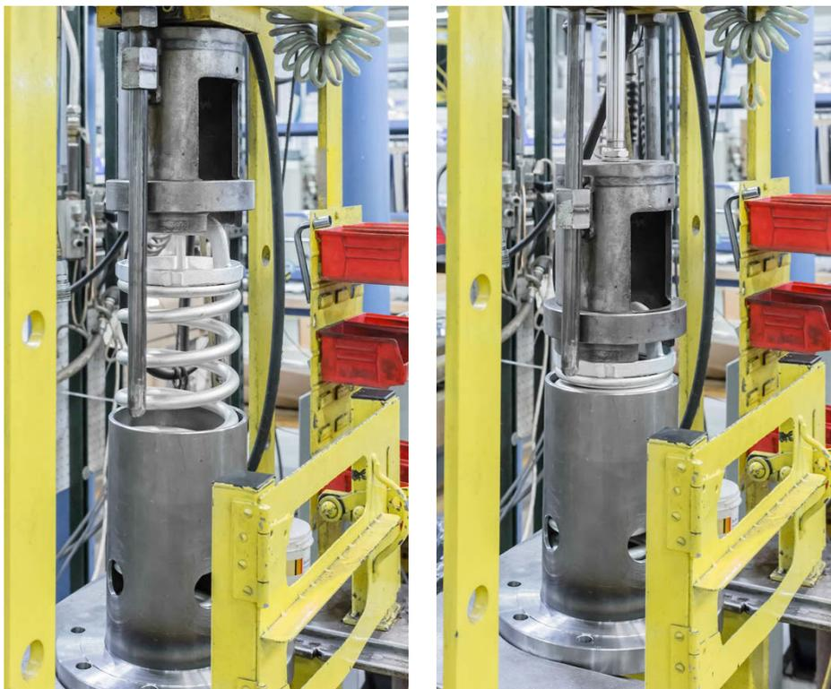
Figura 3-10 Compresión del resorte de la válvula
