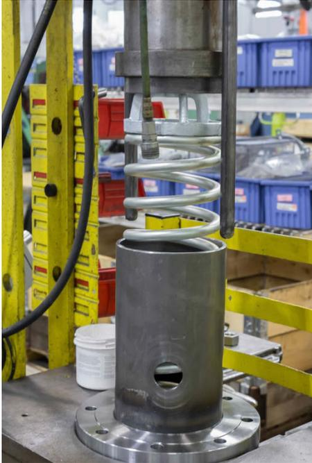
Figura 3-11 Expansión del resorte de la válvula
