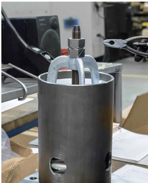
Figura 8-9 Aplicación del alambre de sellado
