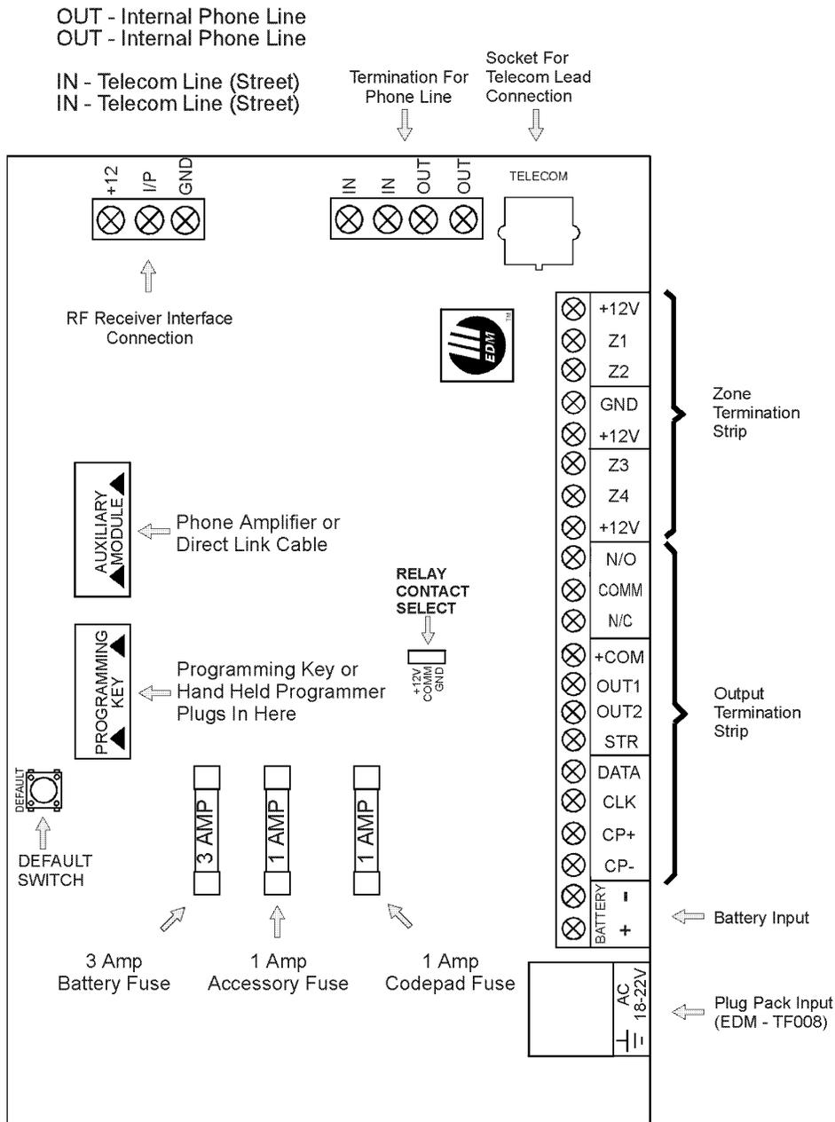
Figura 6: Solution Ultima 862 Disposición de Componentes
