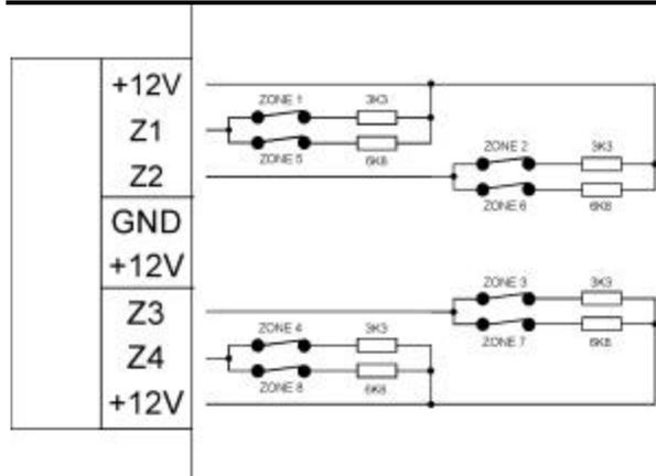
Figura 1: Diagrama de Cableado Split RFL (Posición 266 = 15)
