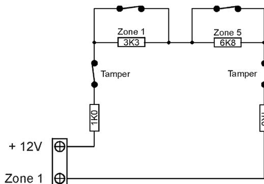
Figura 2: Diagrama de Cableado Split RFL Con Tamper (Posición 266 = 14)
