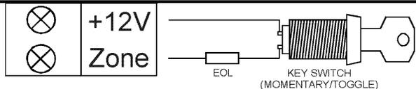
Figura 3: Diagrama de Cableado para la Zona Llave
