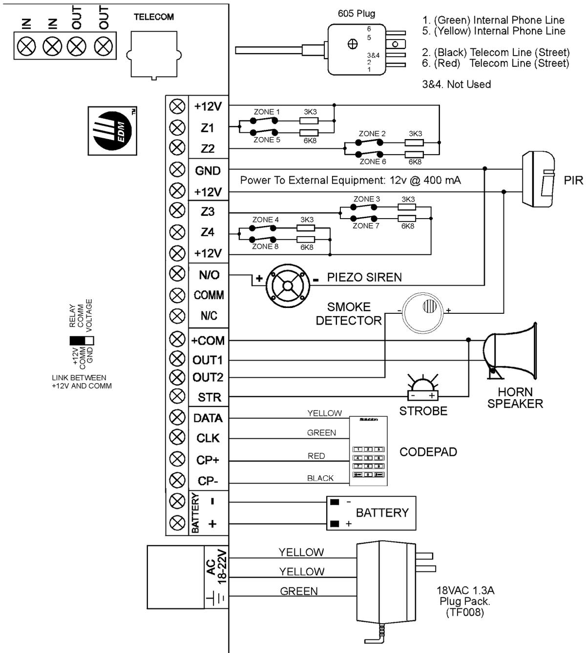
Figura 5: Diagrama de Cableado Solution Ultima 862
