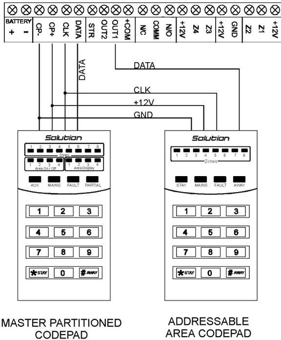
Si el Teclado “CP-5 de Area Direccional (CP500A)” se asigna al **Area 1**, el interruptor DIP Switch n° 1 en la parte posterior del teclado se tiene que colocar en la posición “ON”. Se tienen que programar las siguientes posiciones para la Salida 1 .
