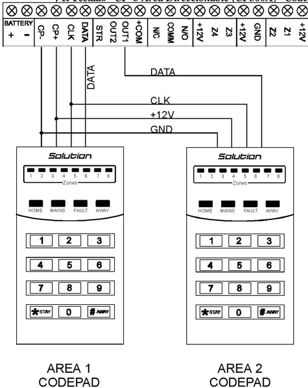
Los siguientes interruptores DIP Switch tienen que ser configurados y programados para los dos Teclados “CP-5 Area Direccional (CP500A)” para funcionar de forma correcta.
