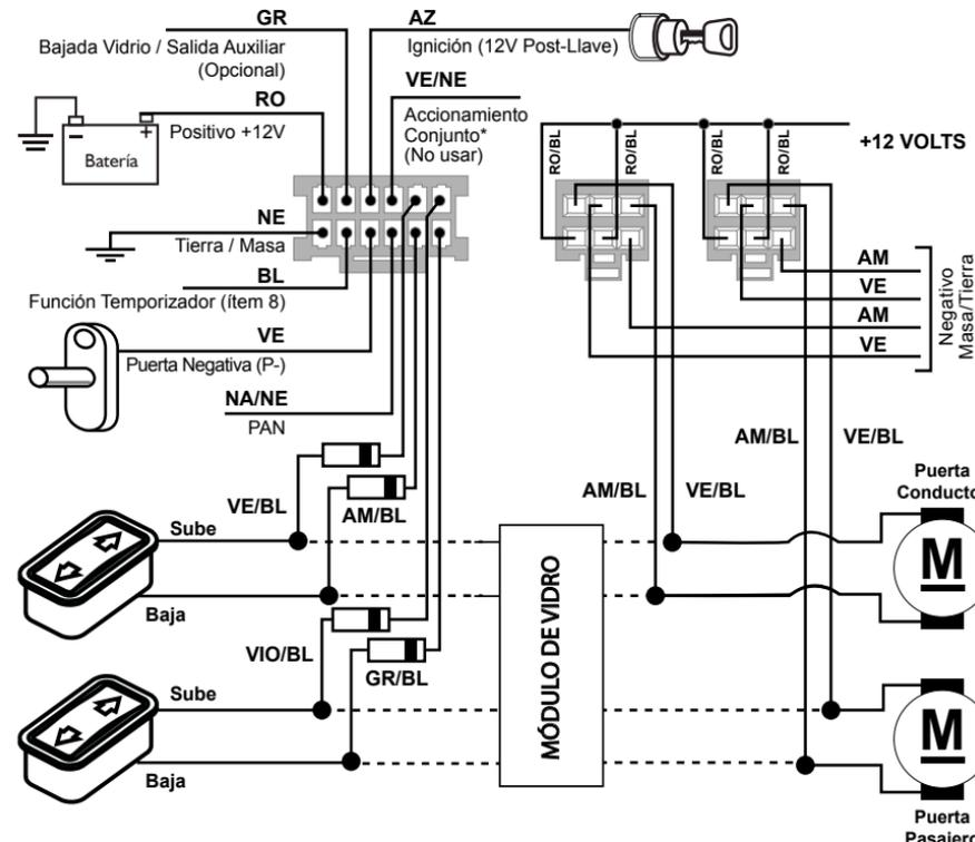
**Observación:** Al conectar el cable NA/NE del módulo Pronnect 440 al NA/NE de la alarma no será necesario instalar los cables VE (puerta negativa), AZ (ignición) y GR (bajada de vidrios). Los diodos en el presente diagrama son para una instalación con teclas en reposo negativo. En caso de ser en reposo positivo, invertir los diodos.
