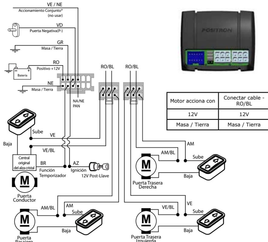
**\* ¡ATENCIÓN!** Instalar únicamente el cable VE/NE (accionamiento conjunto) cuando el alza cristal del vehículo posea la función antipinzamiento.
