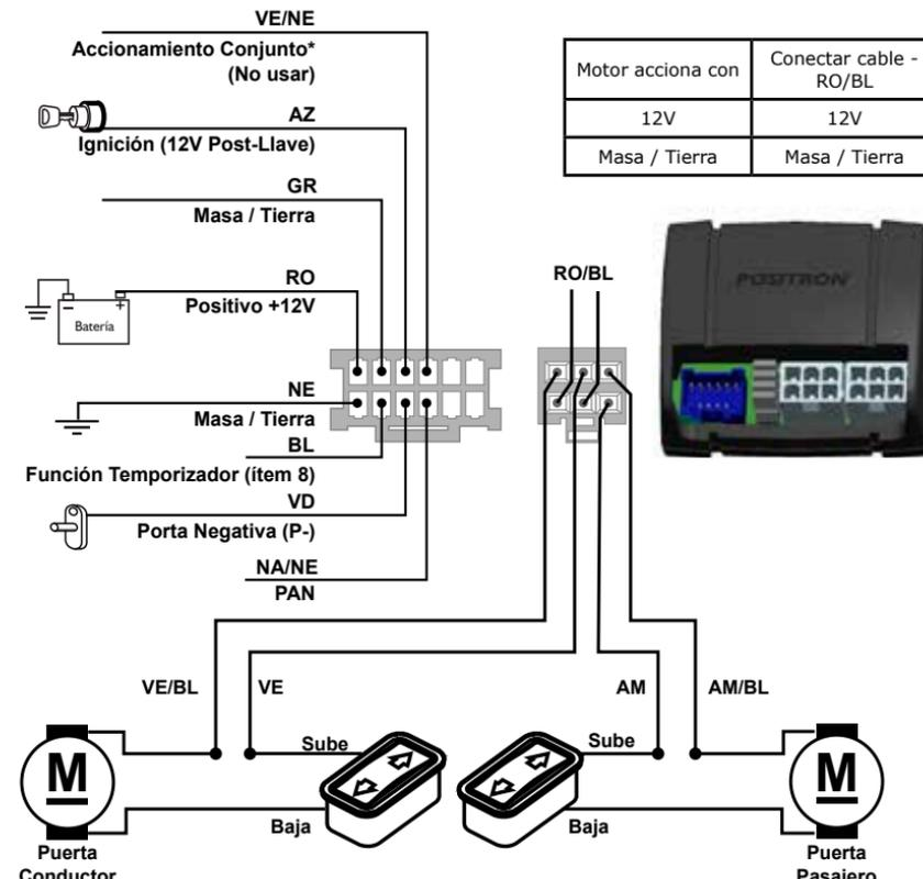
**Observación:** Al conectar el cable NA/NE del módulo Pronnect 240 al NA/NE de la alarma no será necesario instalar los cables VE (puerta negativa) y AZ (ignición).
