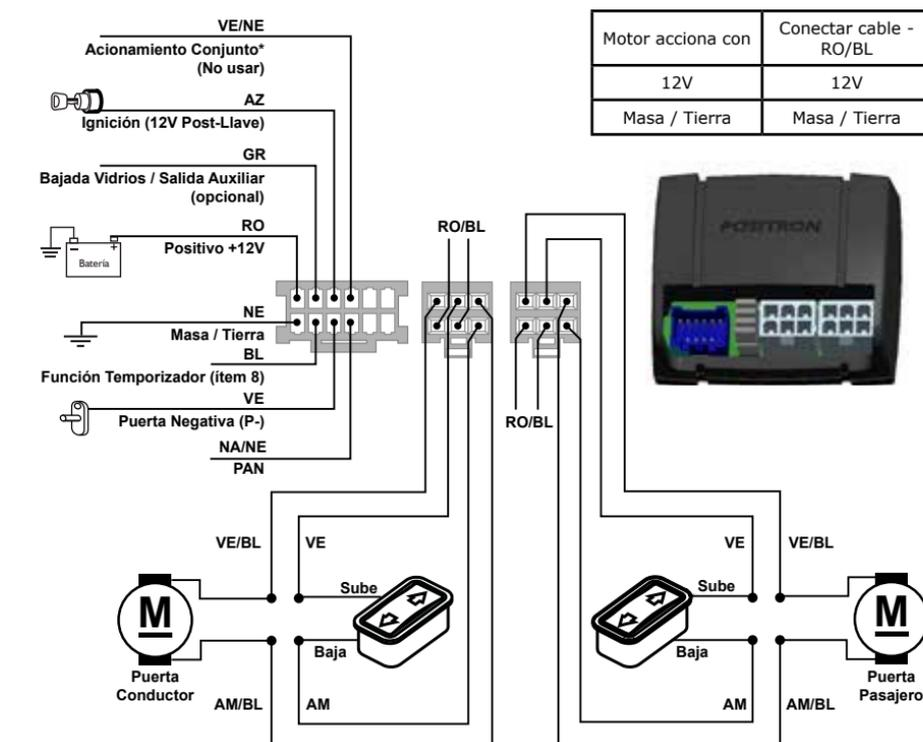
**Observación:** Al conectar el cable NA/NE del módulo Pronnect 440 al NA/NE de la alarma no será necesario instalar los cables VE (puerta negativa), AZ (ignición) y GR (bajada de vidrios).
