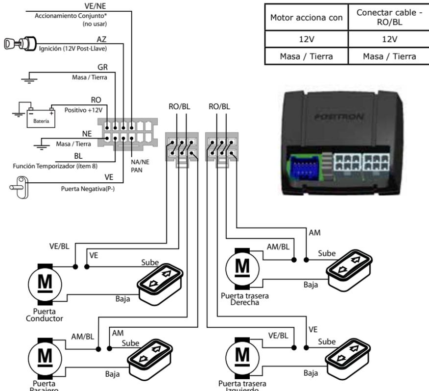
**Observación:** Al conectar el cable NA/NE del módulo Pronnect 440 al NA/NE de la alarma no será necesario instalar los cables VE (puerta negativa) y AZ (ignición).
