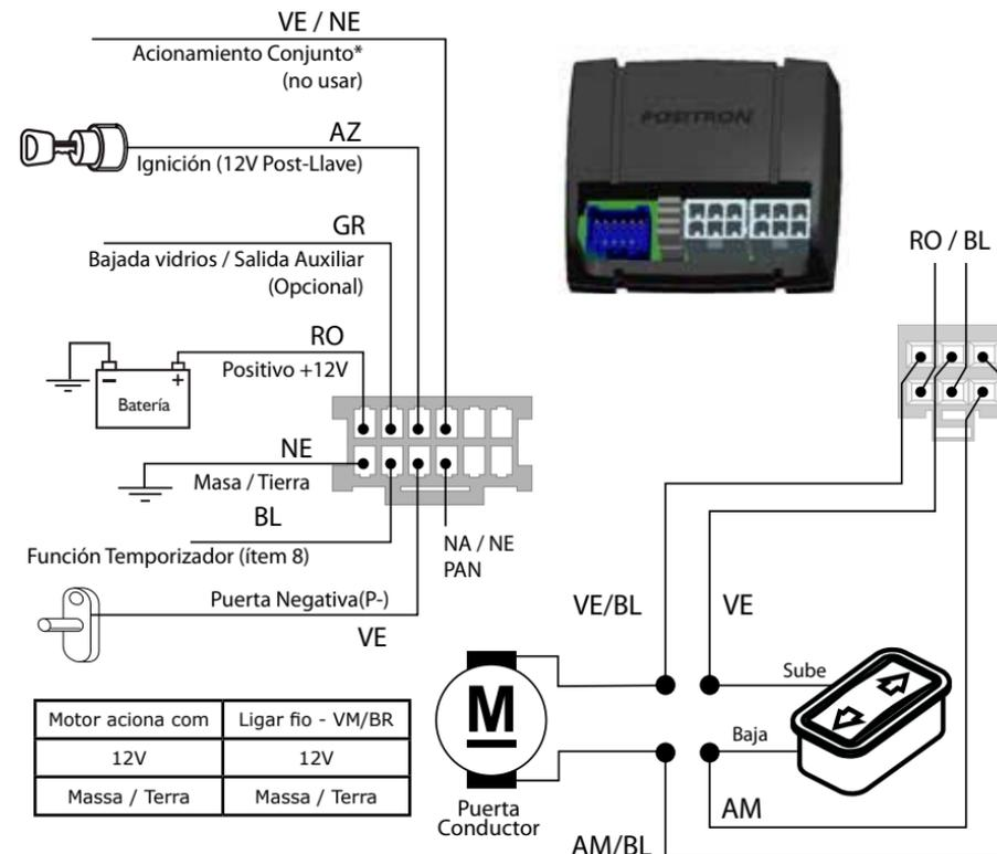
**Observación:** Al conectar el cable NA/NE del módulo Pronnect 240 al NA/NE de la alarma no será necesario instalar los cables VE (puerta negativa), AZ (ignición) y GR (bajada de vidrios).
