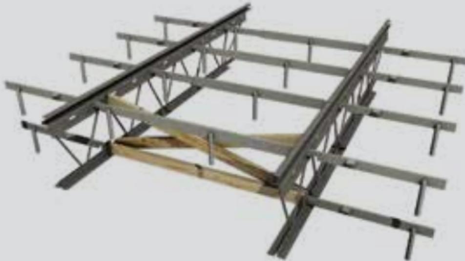
*La línea de arriostramiento transversal temporal está indicada por “X” en los dibujos de instalación emitidos por Canam.*
