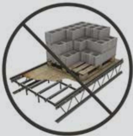
No sobrecargue la losa ni las viguetas durante la construcción con materiales tales como palets de bloques de cemento, mampostería en seco, arena, etc.
