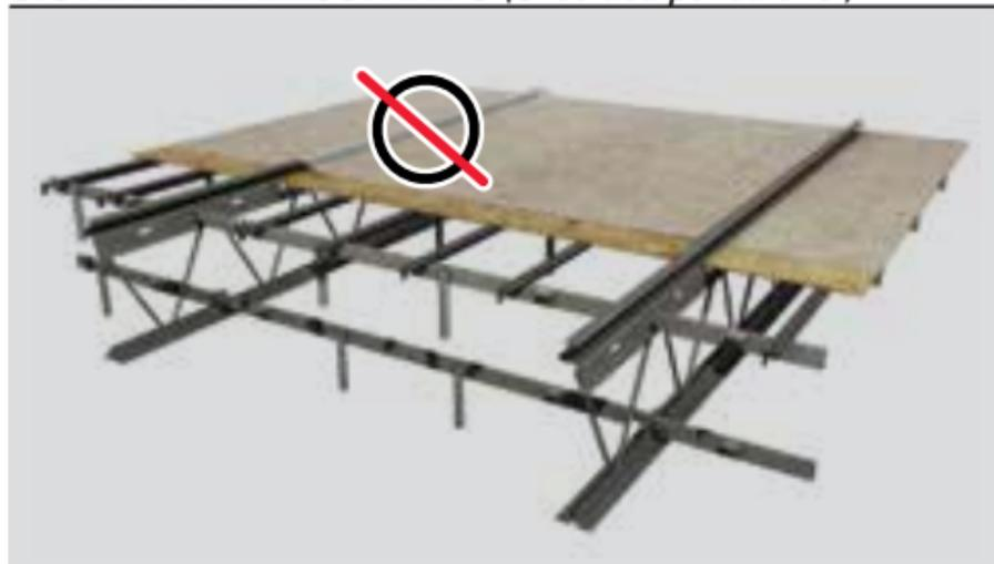
Es posible colocar una lámina de polietileno directamente sobre el contrachapado a fin de protegerlo y facilitar el desencofrado luego. El polietileno nunca debe cubrir las viguetas ni el cordón superior. Nunca se debe cubrir el cordón superior con ningún material, a fin de no afectar la acción compuesta de las viguetas.
