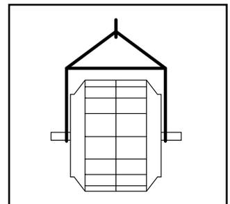
Las ruedas que son embarcadas separadamente pueden ser levantadas por hondas por las paleta y al ededor del cubo. No levanta la rueda por las paletas oni las bridas. Siempre transporte las rueda-porlevantandolas. No mueve la rueda porque esto puede dañar la mano y puede cambiar el volante.
