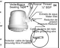
En el caso de que la cañería no coincida con la rosca de ½" BSP use un adaptador. Este adaptador no acompaña la ducha. Abra el registro y deje correr bastante agua para eliminar todas las suciedades del caño. Use cinta veda rosca en el niple de salida del agua del producto.
