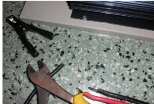
Con el primer cable, medir y quitar el aislante para que el cable entre al fondo de la terminal. Enrolla los hilos del alambre para que queden juntos.
