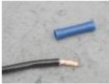
Al entrar el cable asegura que ningún hilo está saliendo del tubo metálico interior. La punta debe quedar a la mitad (para que entre el otro), pero no debe entrar la terminal con cable pelado.
