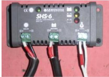
Evitar trabajar con cables bajo corriente, para reducir la posibilidad de un corto-circuito o un choque eléctrico. Por este motivo se estipula conectar el Circuito de Iluminación DC al Regulador cuando las otras partes de la instalación estén terminadas.
