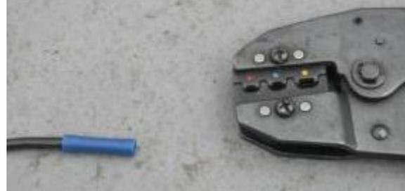
Meter el segundo cable en otro lado de la misma forma. Posicione la terminal a dentro la herramienta de prensado. Posicionarla para prensar el tubo metálico (no solo el aislante exterior), pero sin pasar a la mitad que es del otro cable.
