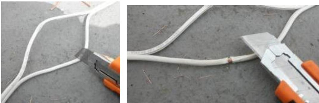
Repetir a 2cm de separación del primer corte. Quitar el aislante con un corte horizontal entre ambos cortes anulares.
