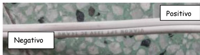
Si el cable es de dos colores, el blanco se trata de positivo, y el negro de negativo. Es preferible demarcar empalmes con cinta aislante (rojo para el cable positivo y negro para el cable negativo.) También se debe demarcar los 6 cables que entran el Regulador con cinta aislante, y los puntos de conexión a la batería - al menos los positivos, para mantener control de la polaridad.
