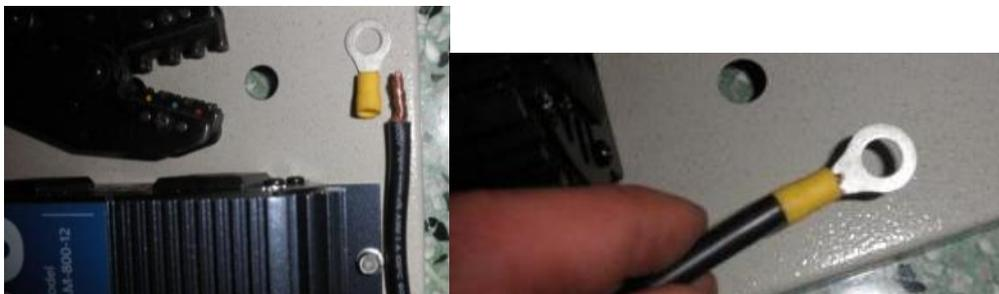
Al entrar el cable asegure que ningún hilo de cable esté saliendo del tubo metálico interior. Si el cable del Inversor es muy grueso, se puede quitar unos pocos hilos si hace falta. La punta debe pasar al fondo y no debe entrar la terminal con cable pelado.
