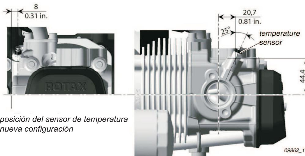
posición del sensor de temperatura nueva configuración
