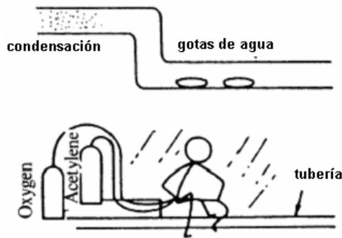
**5.5** Se deben aislar tanto la línea de líquido como la de gas para evitar condensación de agua. Se debe utilizar aislante para cubrir las conexiones de tubería a cada unidad. Utilizar un aislamiento que soporte una temperatura de 120° C o más.
