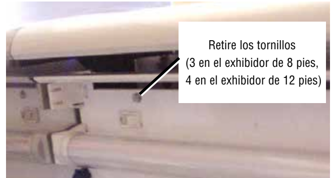
Retire el ensamble de la lámpara frontal para acceder a los tornillos
