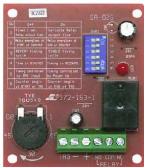
El módulo de temporizador programable **SA-025Q** es apropiado para un amplio rango de operaciones de seguridad temporizada y control de acceso, como cronometraje de apertura de puerta, temporizador de sirena o campana, temporizador VCR y demás. La sensibilización automática del voltaje de entrada y los interruptores DIP para programación hacen que la instalación sea sencilla.
