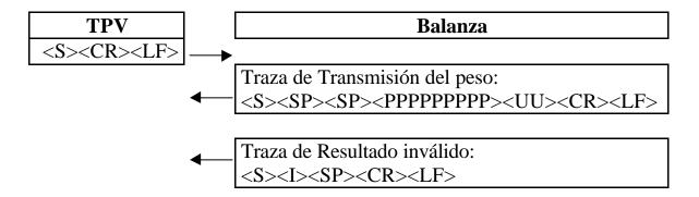
La balanza debe responder en menos de 5 s. La traza de peso si el peso es estable, ha variado desde la última petición, el peso está en rango y la balanza no está haciendo autocero. Si no se dan estas condiciones la balanza retorna la traza de Resultado inválido.
