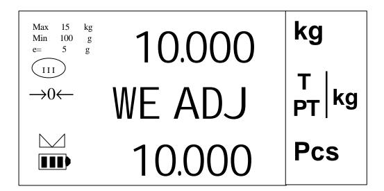
Para volver al modo básico de trabajo se vuelve a pulsar el botón de calibración, quedando en ese momento ajustado el cero y el peso de la balanza.
